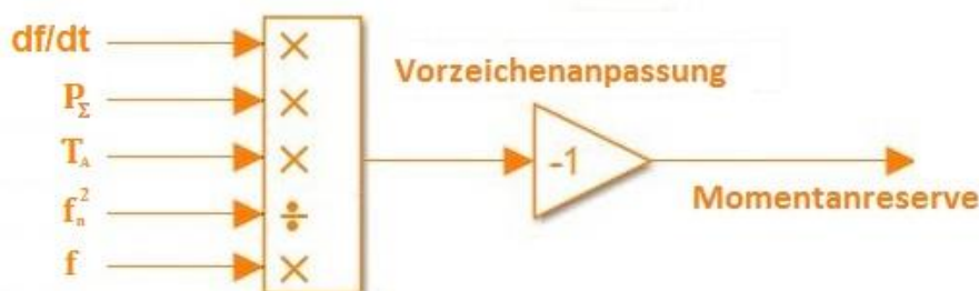
Abbildung 3.2: Prinzip Schaltung zur Berechnung der Momentanreserve
