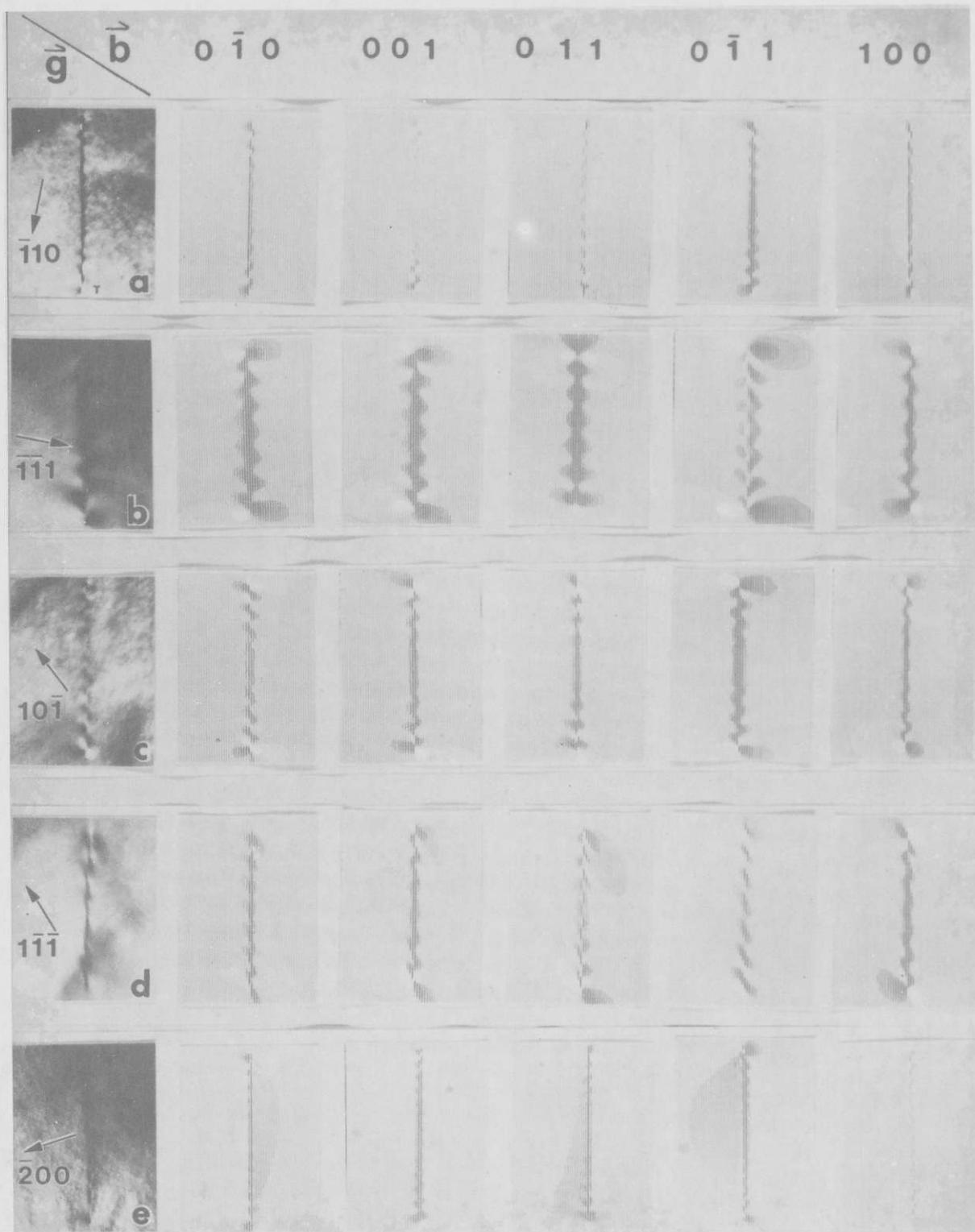
Abbildung 3.3.2: Eine Versetzung in nicht stöchiometrischem  $\text{BaTiO}_3$ . Die Versetzungslinie schließt mit dem Burgersvektor einen  $72^\circ$  Winkel ein. Die Bilder (a)-(e), die den Beugungs- kontrast der Versetzung zeigen, wurden unter Zweistrahlbeding- ungen erhalten. Diese Bilder und Bilder, die für gleiche Abbil- dungsparameter aber unterschiedliche Burgersvektoren berechnet wurden, werden miteinander verglichen.
