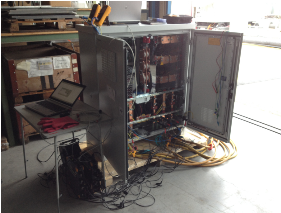
Abbildung 3.22: Messaufbau zur Funktionsprüfung von Strangregler G
