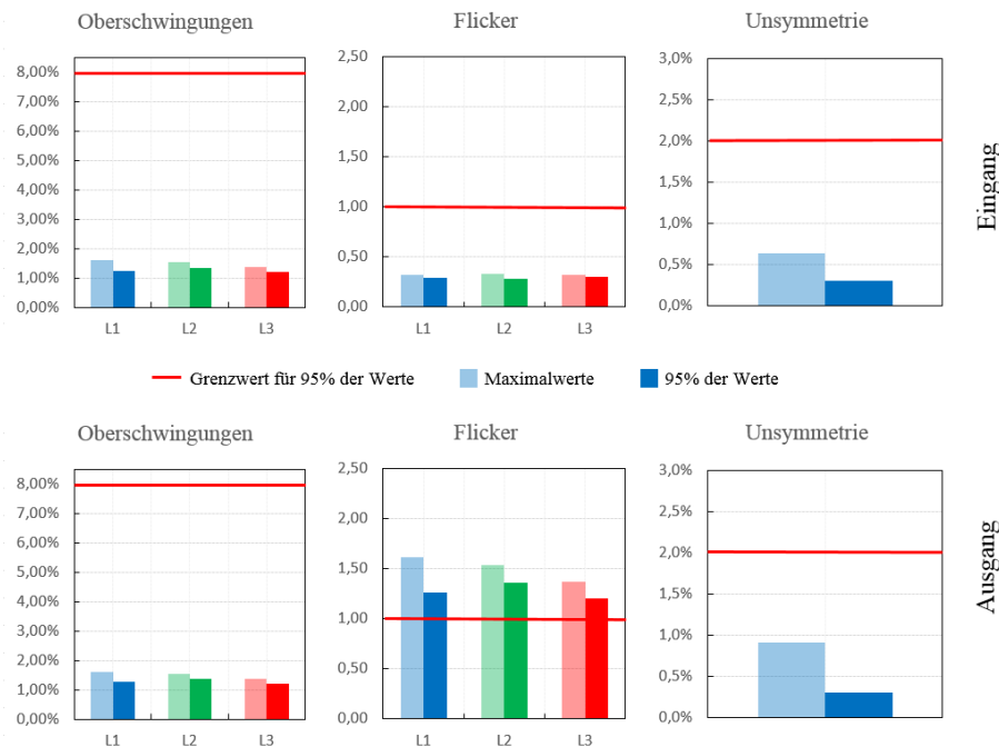
Abbildung 3.14: Messergebnisse (THD, P_t und Unsymmetrie-Werte) Strangregler B, Betrachtungszeitraum: 02.03.2102 00:00 bis 09.03.2012 00:00
