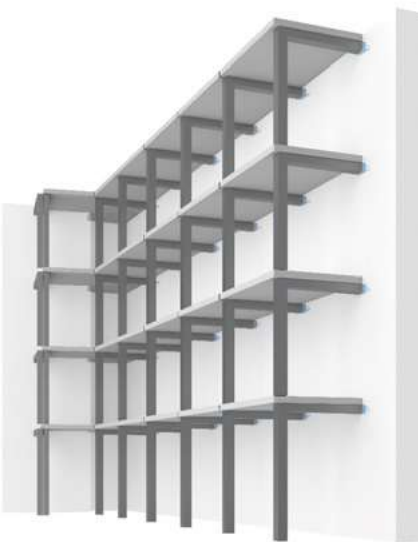
Abb. 211: Kirchdorfer Laubengangsystem (concrete-solutions.eu)
