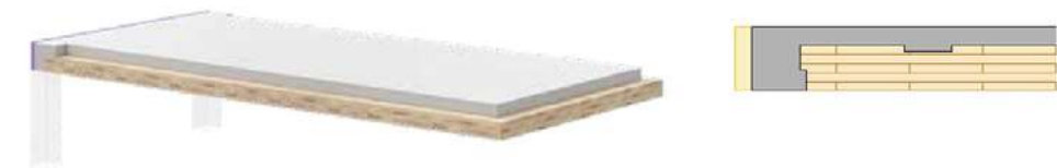
Abb. 205: XC® Living Plus mit Stahlbeton-Randbalken (MMK, 2022)
