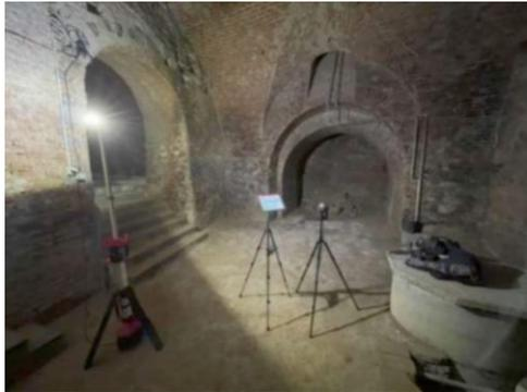
**Abb. 125** Vermessung einer komplexen Gewölbestruktur im vierten Kellerraum
