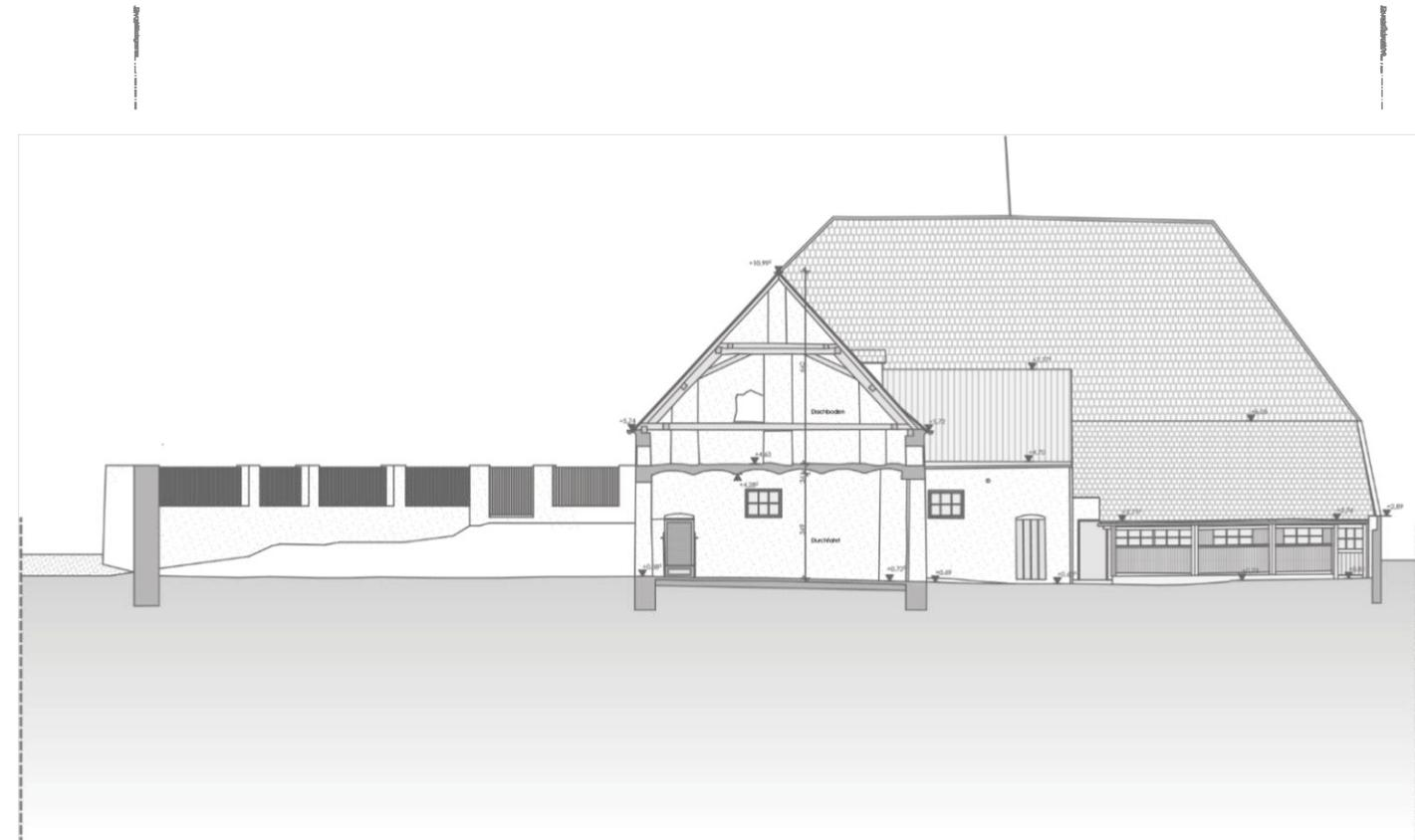
Abb. 163 Bestandsplan Schnitt 7-7 M 1:250
