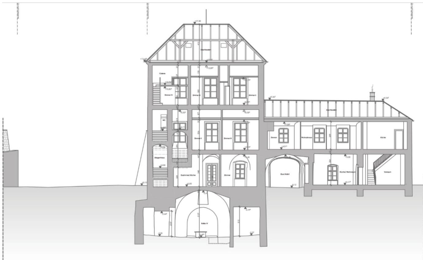
Abb. 158 Bestandsplan Schnitt 2-2 M 1:250
