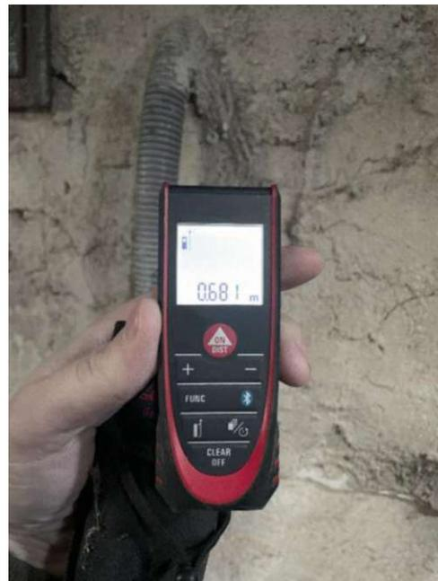
**Abb. 121** Abstandsmessung mittels Lasermessgerät
