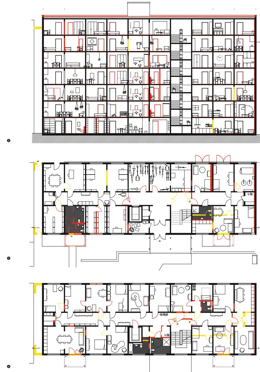
**Abb. 62** Schnitt und Grundriss mit Abbruch und Neubau
