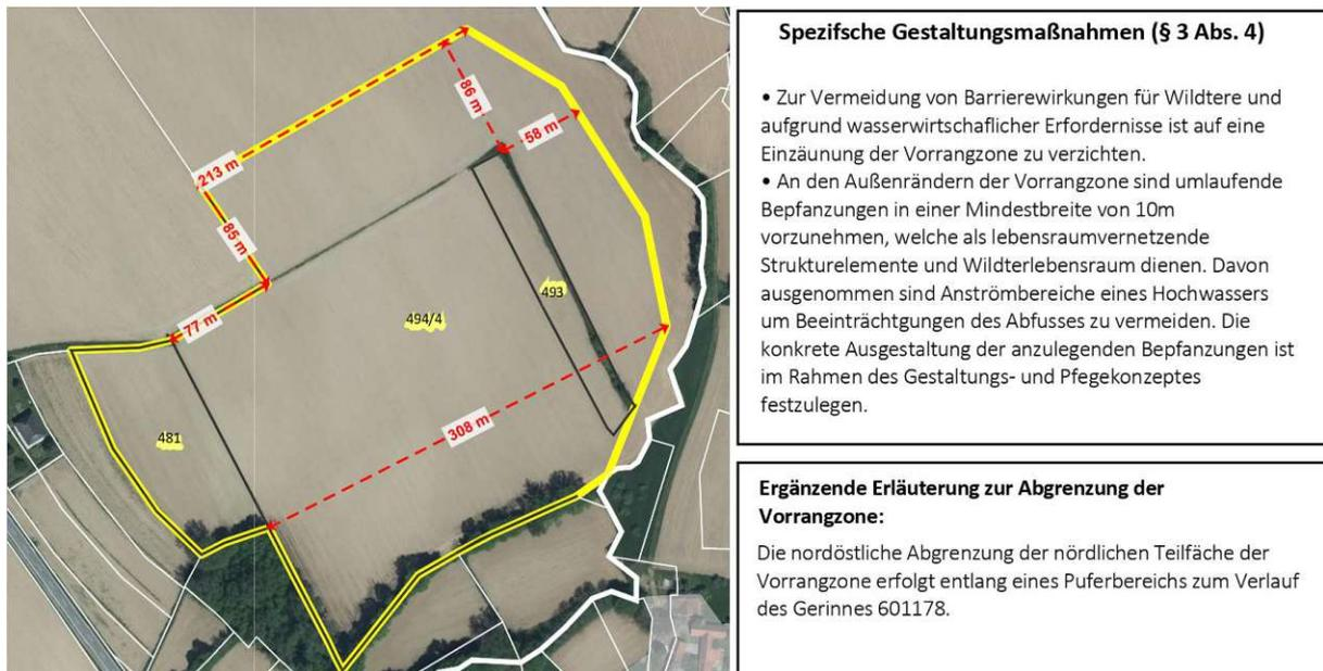
**Abbildung 16: Darstellung einer PV-Vorrangzone inklusive Spezifikationen in der Steiermark** (adaptiert aus Verordnung der Steiermärkischen Landesregierung, mit der ein Entwicklungsprogramm für den Sachbereich Erneuerbare Energie – Solarenergie erlassen wird, 2023, Anlage 2.06)
