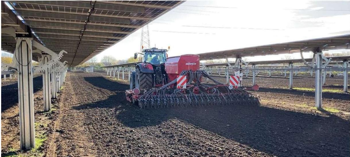
**Abbildung 9: Maschinelle Bewirtschaftung in einer Agri-PV-Anlage im Ackerbau** (EWS Consulting GmbH, 2024)
