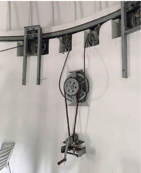
Abb. 175 Kurbelwerk des Öffnungsmechanismus
