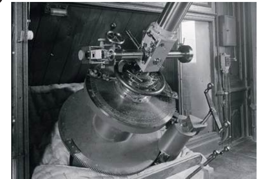
Abb. 81 Okularende des Äquatorial Coudés mit dem Spektrographen, o.J.
