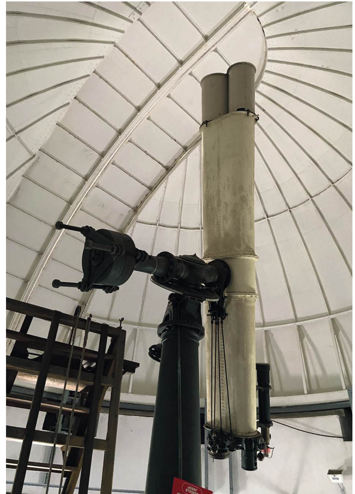
Abb. 204 Verfärbungen an der Oberfläche des Astropographen, Photographischer Pavillon
