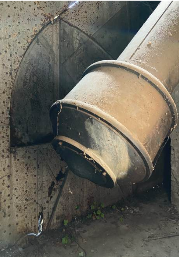
Abb. 311 Gegengewicht am Polrohr, Äquatorial Coudé
