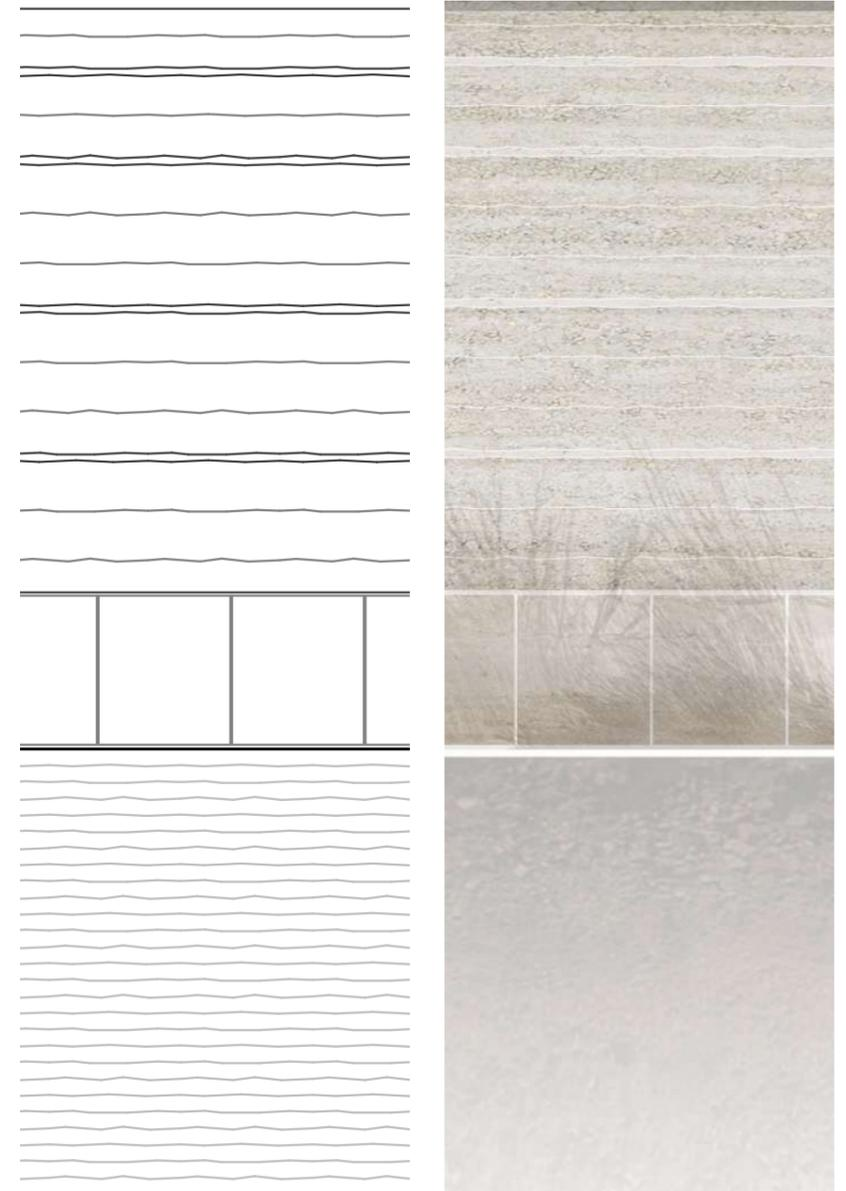
Abb.68: Liniengrafik und Ansicht, Stampflehmwand mit Trasskalkleisten und Sockelschutz aus Natursteinplatten
