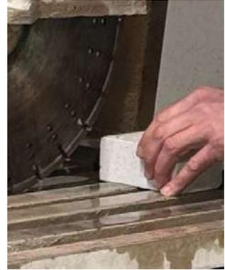
Abb.97.: Schneiden des Block aus dem Steinbruch Pucisca
