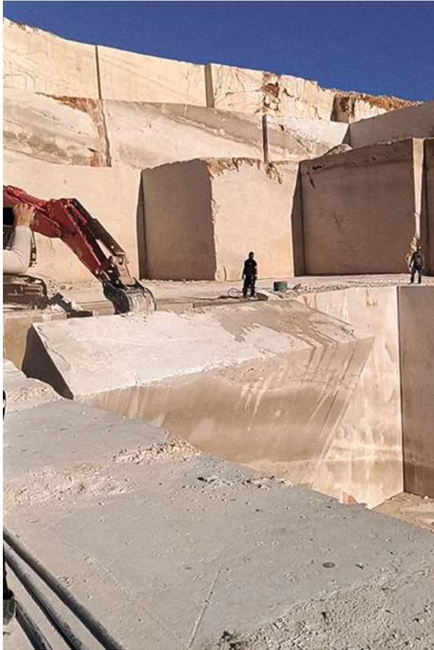
Abb.68.: Umkippen des Primärblocks mit einem Bagger im Steinbruch Veselje
