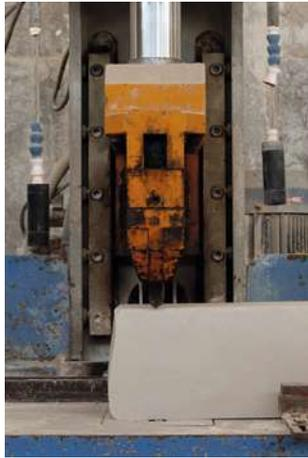
Abb.75.: Stanzgerät. Erzeugung von gewollten Spannungsbrüchen
