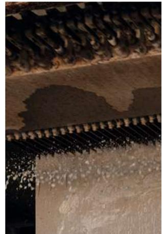
Abb.71.: Zuschnitt des Sekundärblocks zu Plattenformaten
