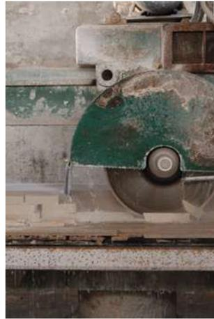
Abb.73.: Zuschneiden der Plattenformate
