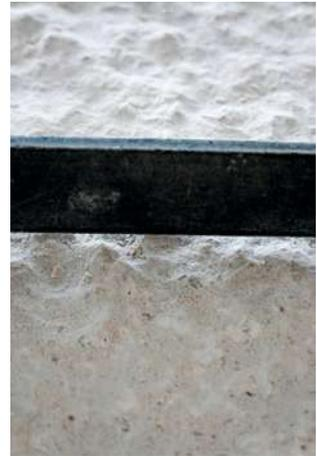
Abb.59.: Licht scheint durch Unebenheiten unter dem Lineal
