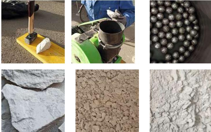
Abb.94.: Materialexperiment, Zerkleinerung des Bracer Marmors in Steinmehl
