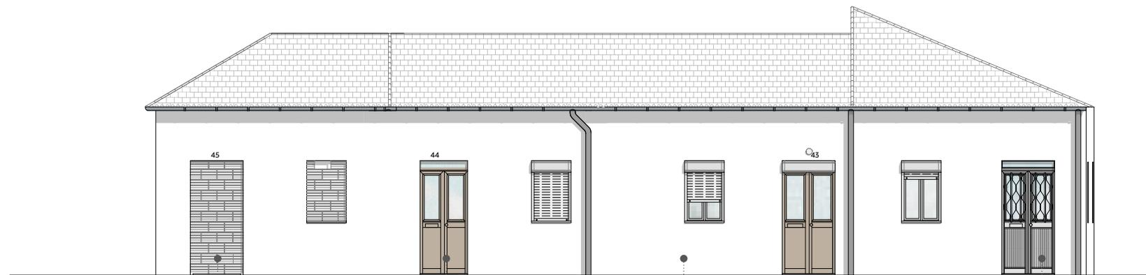
Ziegelverbau      Bestandstüre aus Holz      Granitwände      Bestandstüre aus Aluminium
