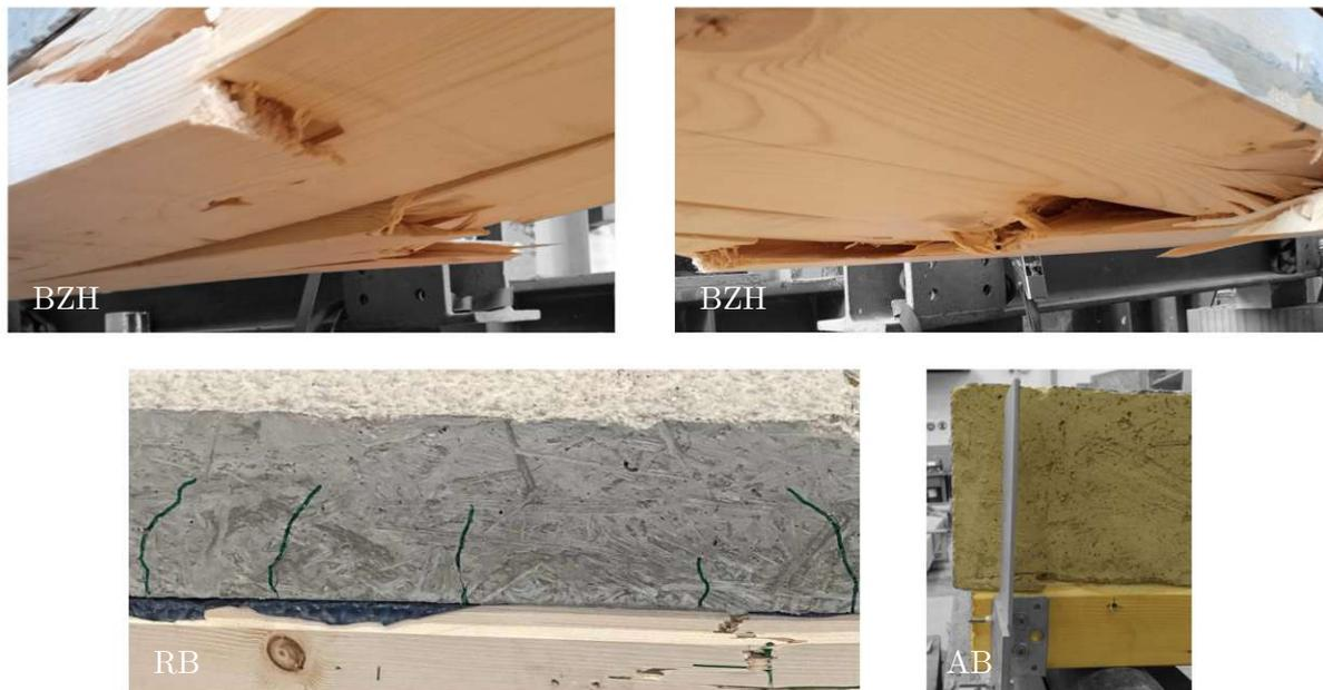
**Abb. 5.25:** Schädigungs-, Versagens- und Systemmechanismen der experimentellen Bruchversuche an großmaßstäblichen Verbundprobekörpern | Versuchsreihe KuTr-BI-Ke
