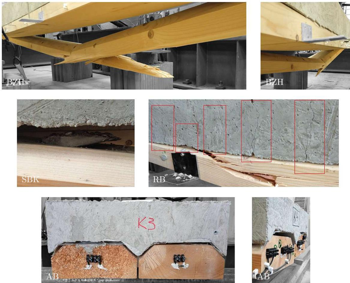
**Abb. 5.24:** Schädigungs-, Versagens- und Systemmechanismen der experimentellen Bruchversuche an großmaßstäblichen Verbundprobekörpern | Versuchsreihe KuTr-Ke
