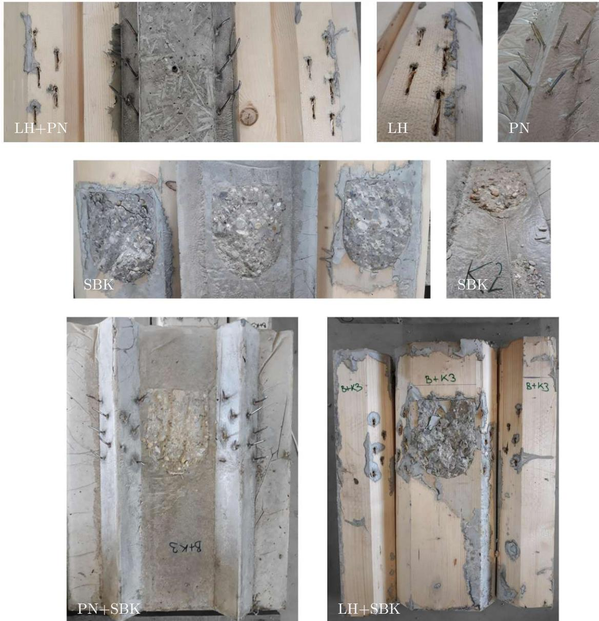
**Abb. 5.14:** Schädigungs- bzw. Versagensmechanismen der experimentellen Bruchversuche an kleinmaßstäblichen Verbundprobekörpern | Versuchsreihe KuPu-BI (oben), Versuchsreihe KuPu-Ke (mittig), Versuchsreihe KuPu-BI-Ke (unten)
