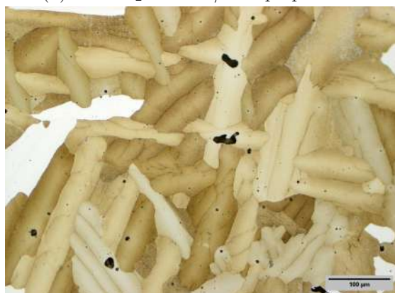
(f) \text{Ti}_2\text{ZrO}_2 1000 °C/24 h perpendicular
