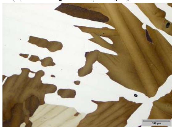
(d) \text{Ti}_1\text{ZrO}_2 1000 °C/24 h perpendicular
