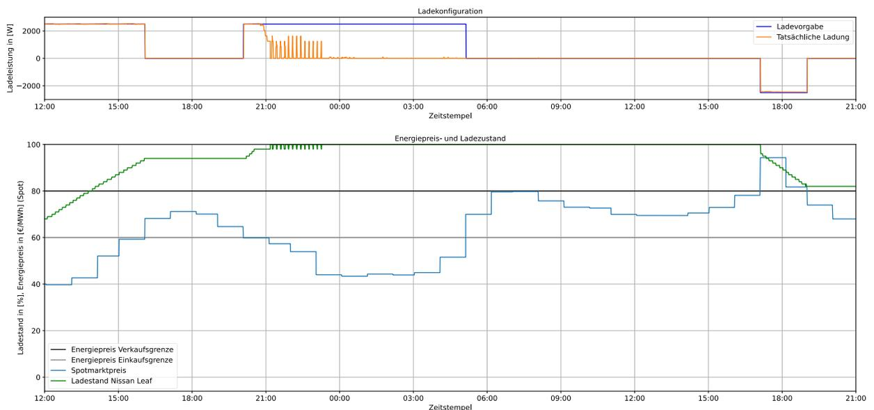
Abbildung 2: Demonstrationsszenario 2. Laden in Abhängigkeit vom EPEX-Preis, Entladung von insgesamt etwa 5,8kWh, die profitabel verkauft werden. (Nichtberücksichtigung der Netzgebühr, grafische Anpassung des Datensatzes)
