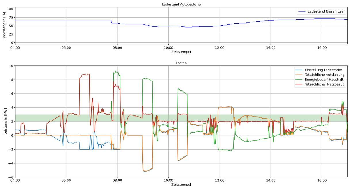
Abbildung 1: Demonstrationsszenario 1. Dämpfung von Lastspitzen durch die Autobatterie. Entladung von insgesamt etwa 3,1kWh um Lastspitzen durch die Wärmepumpe zu dämpfen.
