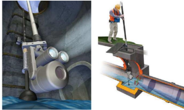
Abbildung 3.3: Prinzipdarstellung elektronische Spiegelung 32
