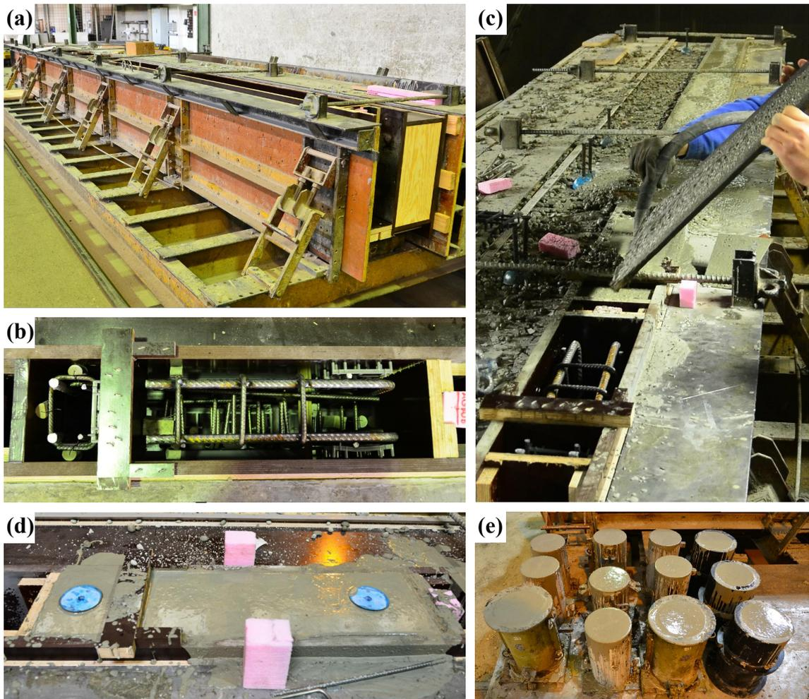
**Abbildung 3.6:** Herstellung der „Push-off“-Körper: (a) Schalungsvorrichtung für drei „Push-off“-Körper und einen Balken; (b) Schalung mit Bewehrungskorb eines „Push-off“-Körpers von oben; (c) Einbau des Frischbetons über eine Rutsche (im Vordergrund) und Verdichtung mittels einer Rüttelflasche (im Hintergrund); (d) frisch betonierter „Push-off“-Körper mit zwei Transportankern; (e) frisch betonierte Zylinder für Materialtests.
