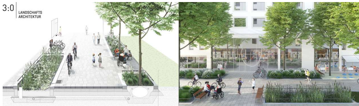
Abb. 4.18: Schema und Rendering einer Straße nach dem Schwammstadtprinzip Quelle:[35]
