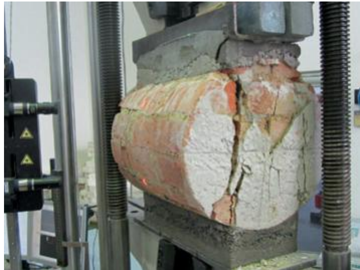
Abb. 20: Spaltzugprüfung am Bohrkern [13]
