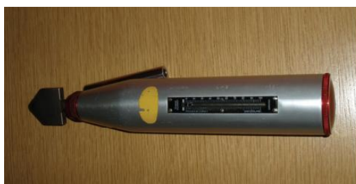
Abb. 21: Links: Rückprallhammer; Rechts: Schnitt durch den Rückprallhammer nach Schmidt [19]
