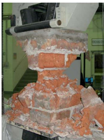
Abb. 19: Druckversuch am Mauerwerkspfeiler [13]
