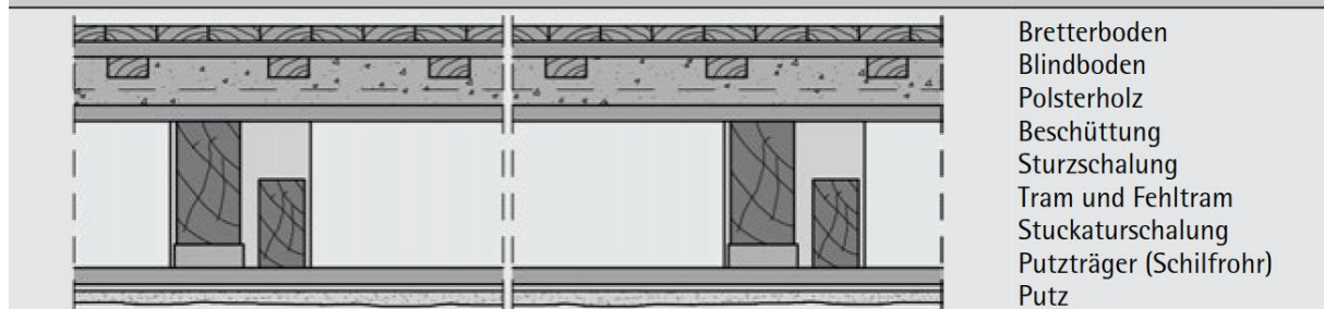
Abb. 9: Querschnitt einer Fehltramdecke [11]
