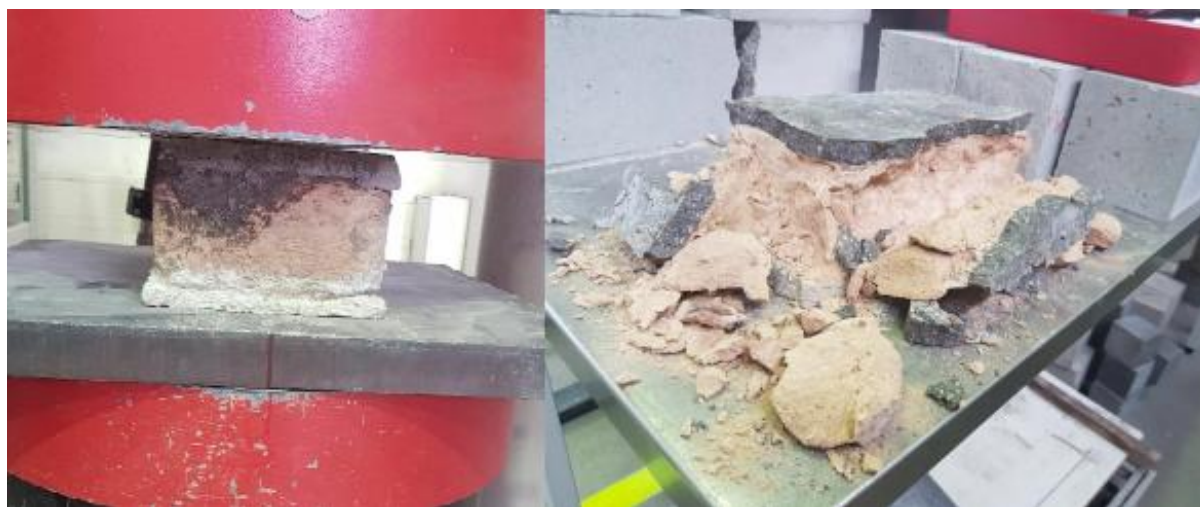
Abb. 16: Links: Druckversuch am Ziegel; Rechts: Versagensbild des Ziegels [15]
