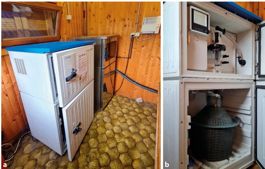
Abb. 2 a Die beiden automatischen Probenehmer an der Messstation an der Wulka. b Der geöffnete Probenehmer mit der Vakuum-Probenahmeeinrichtung oben und dem 25-L-Probenbehälter unten
