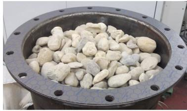
Abb. 3.9: Drainageschotter im Schüttungsbehälter
