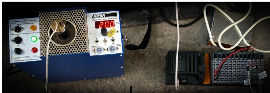
Abb. 4.1: links: Kalibrierofen Jofra 600S mit PT100; rechts: Steuerungscomputer X20 von B&R mit angeschlossenem PT100 Thermofühler
