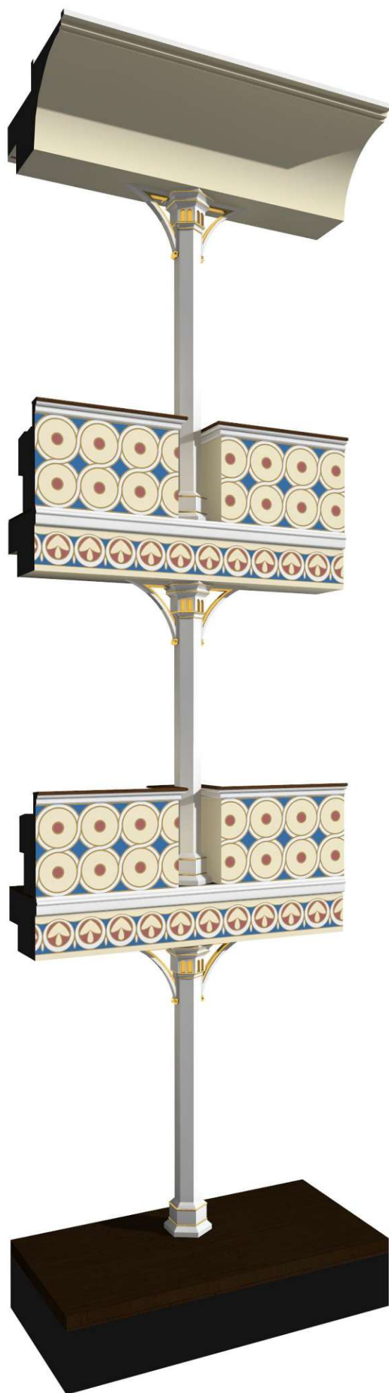
links, Abb. 4-89: Visualisierung der rekonstruierten Stützen mit Brüstung rechts, Abb. 4-90: Visualisierung der rekonstruierten Eckpfeiler mit Brüstung
