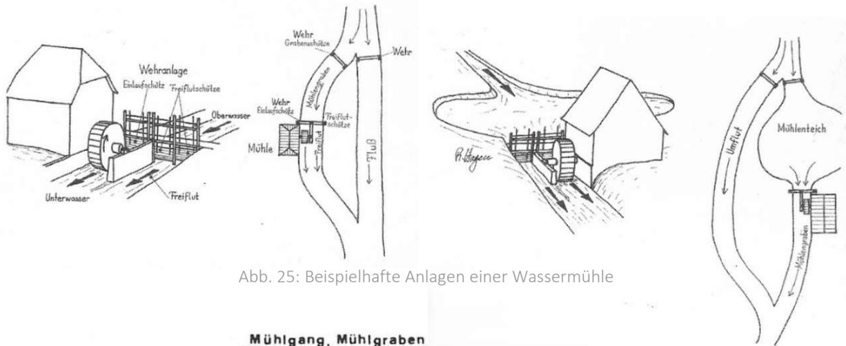
Abb. 25: Beispielhafte Anlagen einer Wassermühle
