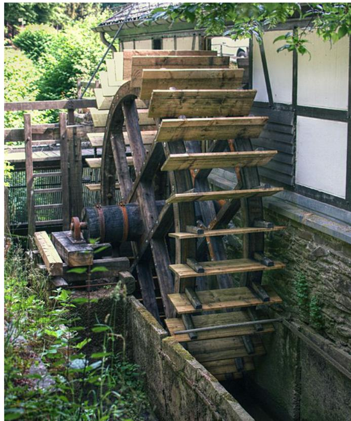
Abb. 42: Strauberrad des *Balkhauser Schleifkotten* in Solingen. Die Schaufeln des Rades wurden hier an zwei Kränzen befestigt
