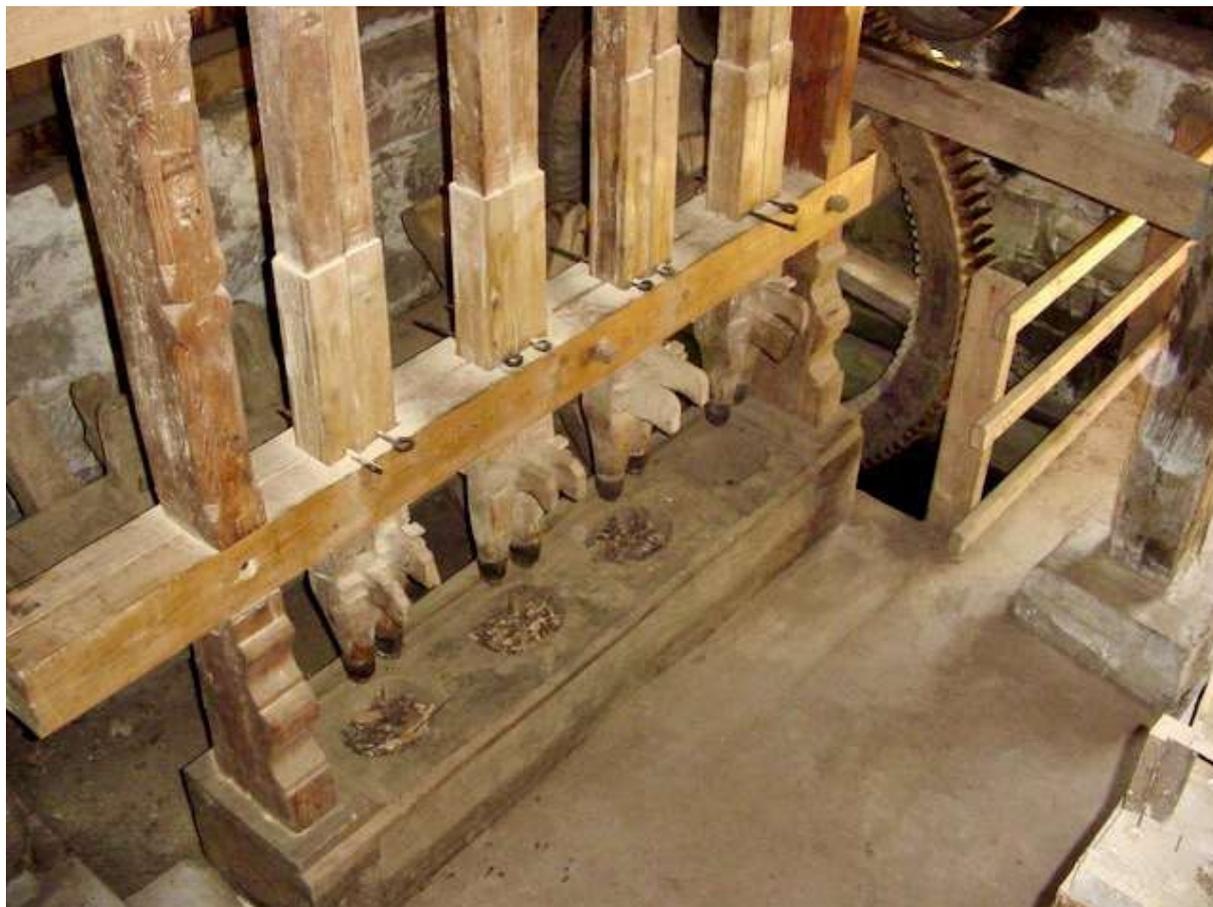
Abb. 84: Stampfwerk der Brandhofer Ölmühle in Gschwend.
