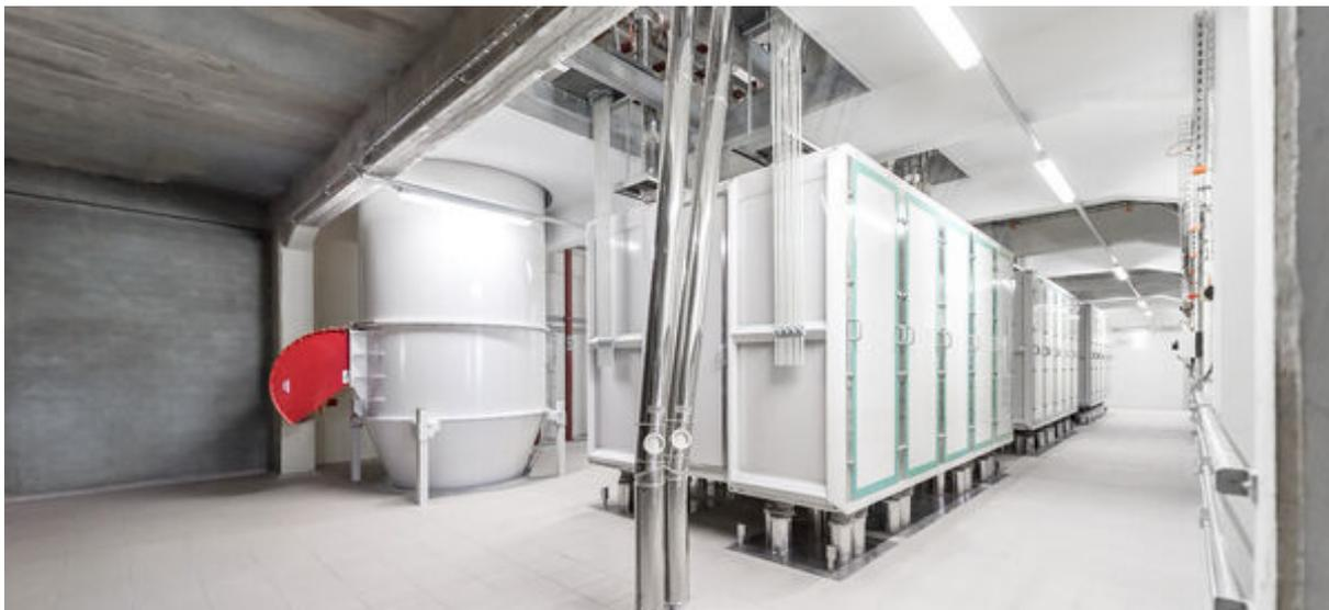
Abb. 108: Moderner Sichterboden der industriellen Großmühle in Recklinghausen.
