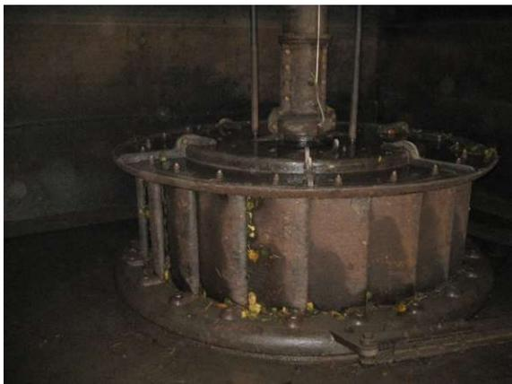
Abb. 54: Geschlossener Leitapparat in einer Francis-Schachtturbine.
