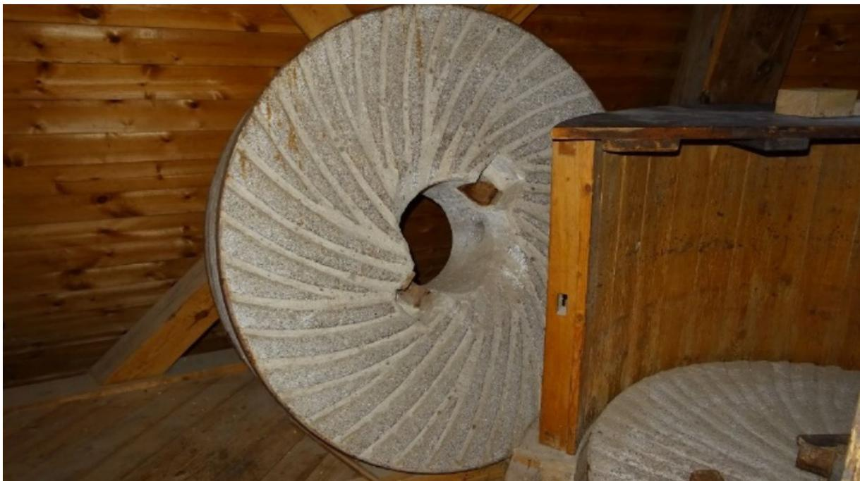
Abb. 98: Abgenommener Läuferstein mit gut erkennbaren Furchen sowie der Ausnehmung für die Haue.
