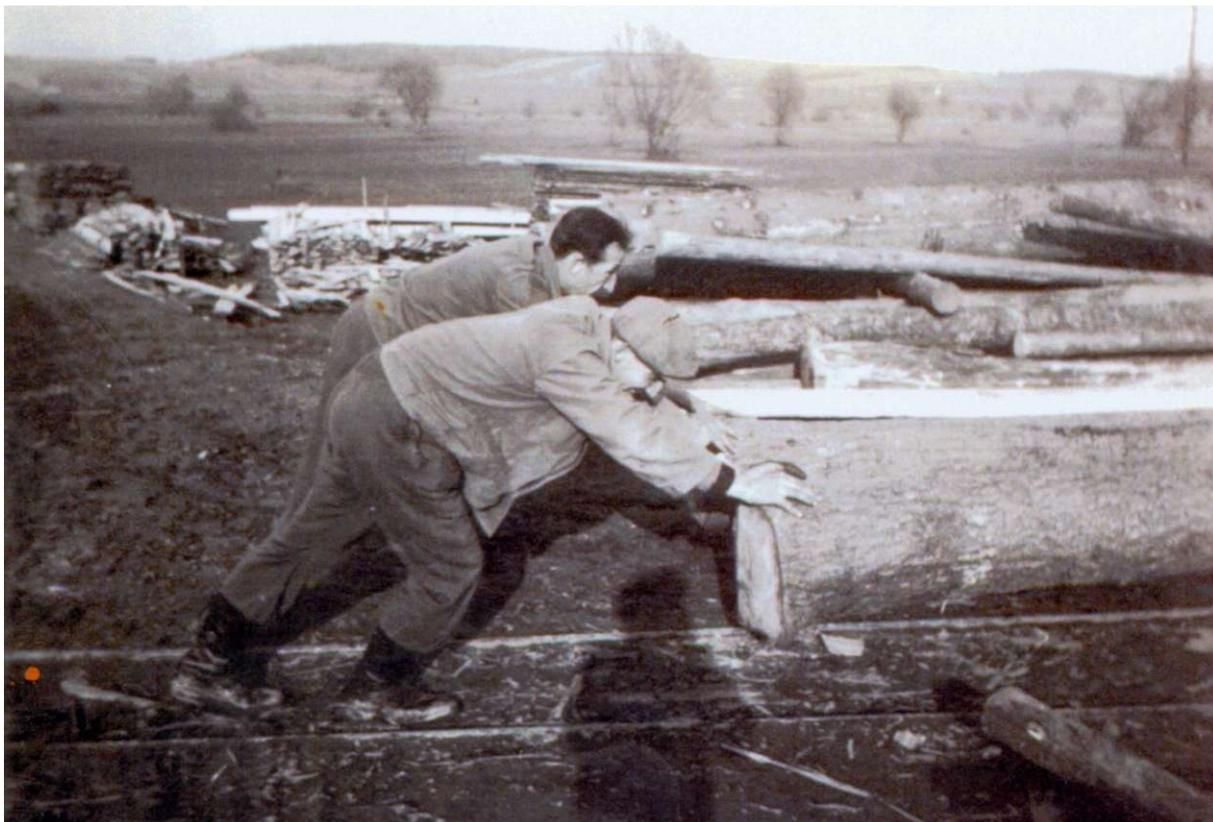
Abb. A11: Arbeiten im Sägewerk. Die Männer bewegen einen Baumstamm mithilfe des Schienensystems.
