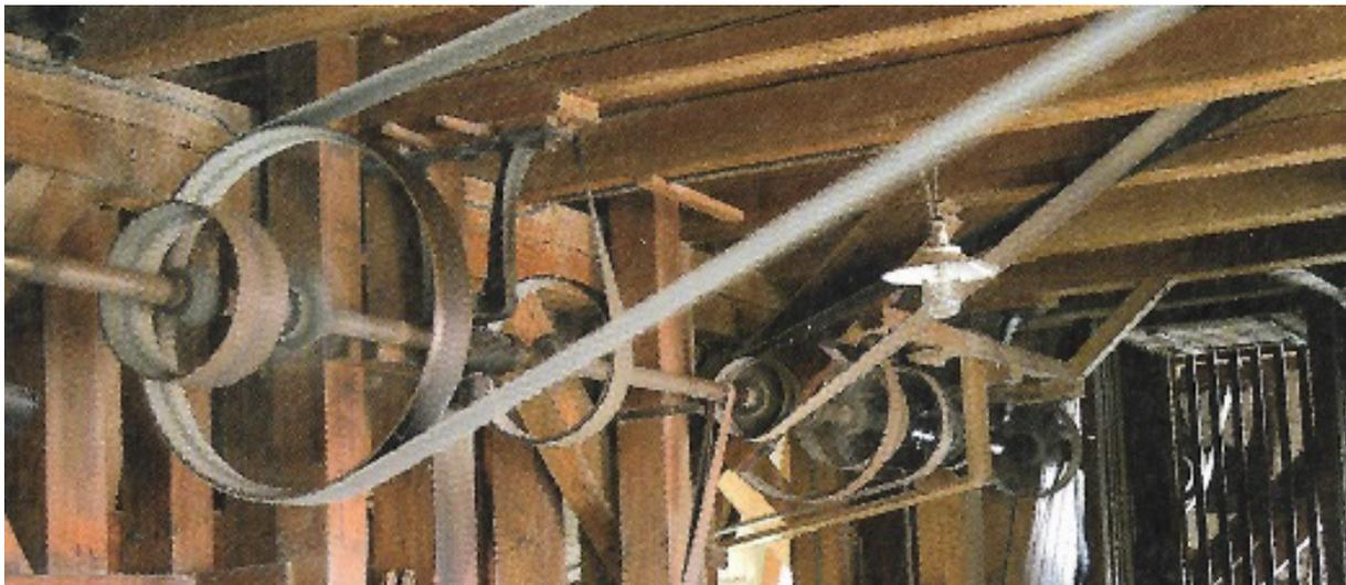
Abb. 106: Riemen-Transmission in einer Getreidemühle.
