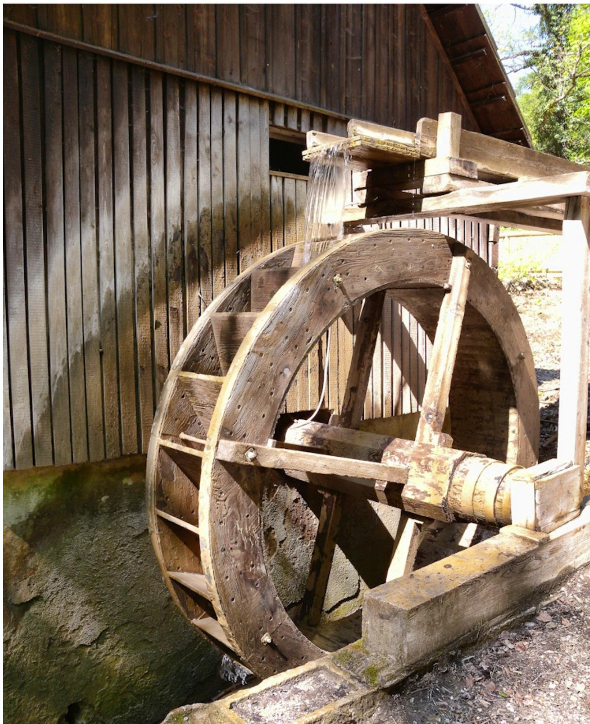
Abb. 44: Oberschlächtiges Wasserrad mit gut erkennbaren Zellen und Zulaufrinne.
