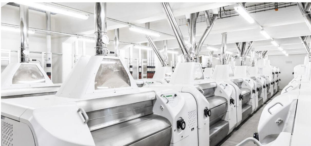
Abb. 110: Moderner Walzenboden der industriellen Großmühle in Recklinghausen.
