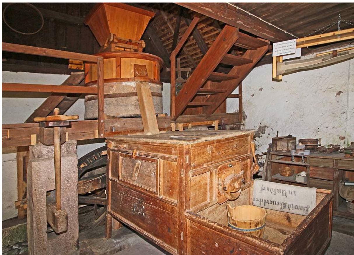
Abb. 105: Gesamtübersicht eines Mahlgangs mit angeschlossenem Beutelwerk. Auch das Kammrad ist sichtbar.
