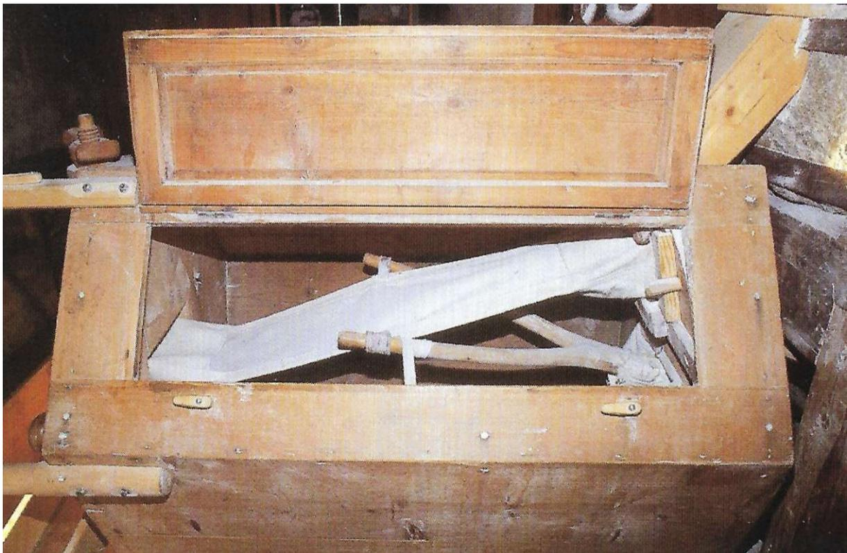
Abb. 101: Geöffneter Beutelkasten mit sichtbarem Leinenbeutel und Beutelgabel. (Hinterlochermühle in Ellbögen in Tirol).
