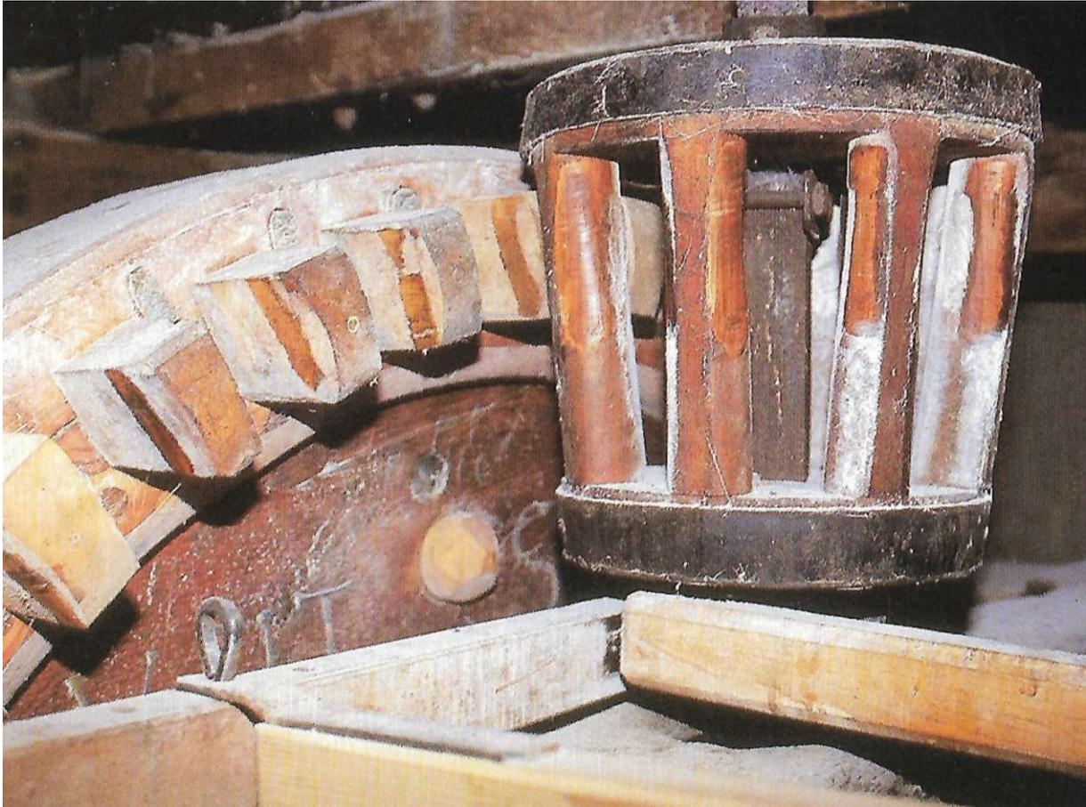
Abb. 90: Kammrad und Stockgetriebe mit Mühleisen der „Hinterlochermühle“ in Ellbögen in Tirol.
