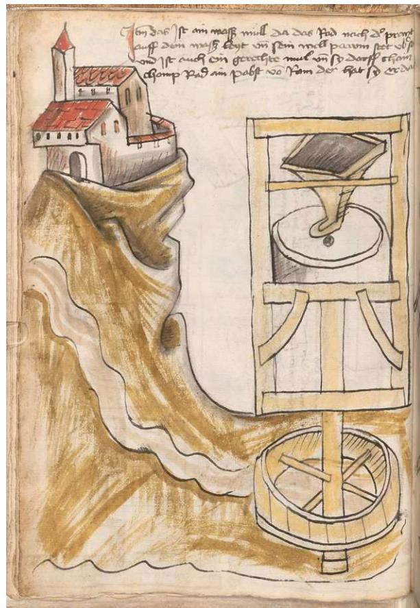
Abb. 13: Älteste bekannte Darstellung einer horizontalen Wassermühle, erstellt von Anonymus der Hussitenkriege um 1430. (Vgl. MAGER 1988, S. 53.)
