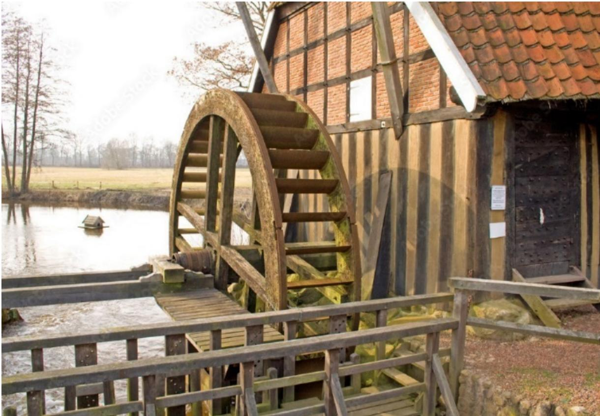
Abb. 40: Staberrad der Wind- und Wassermühle in Hüven.
