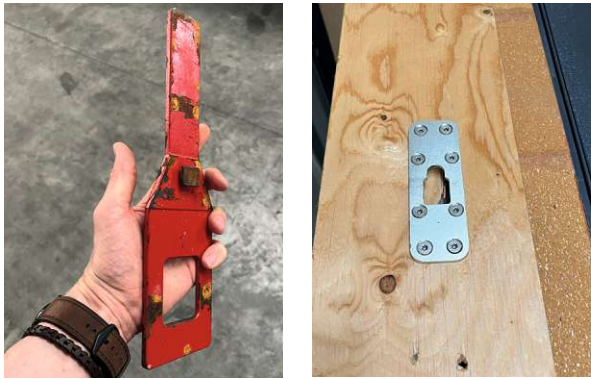
Abb. 37: Spezialwerkzeug und Anschlag der Fassaden- elemente, Florian Schreiber, 17.07.2025
