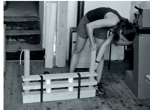
ABB.87: ZWEITE PAPPSTÜTZE IN AUSBOHRUNG STECKEN
