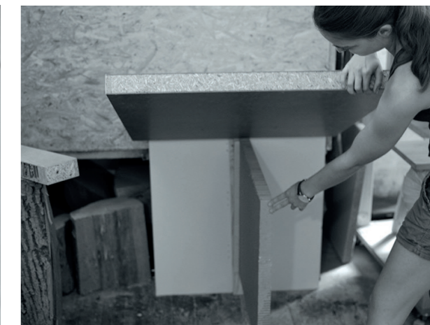
ABB.107: KLAPPSYSTEM : LEICHTBAUPLATTE TISCH, AUFLAGEPLATTE PAPPKARTON
