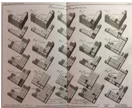
Abb. 41 Mauerwerk aus Ziegelstein
