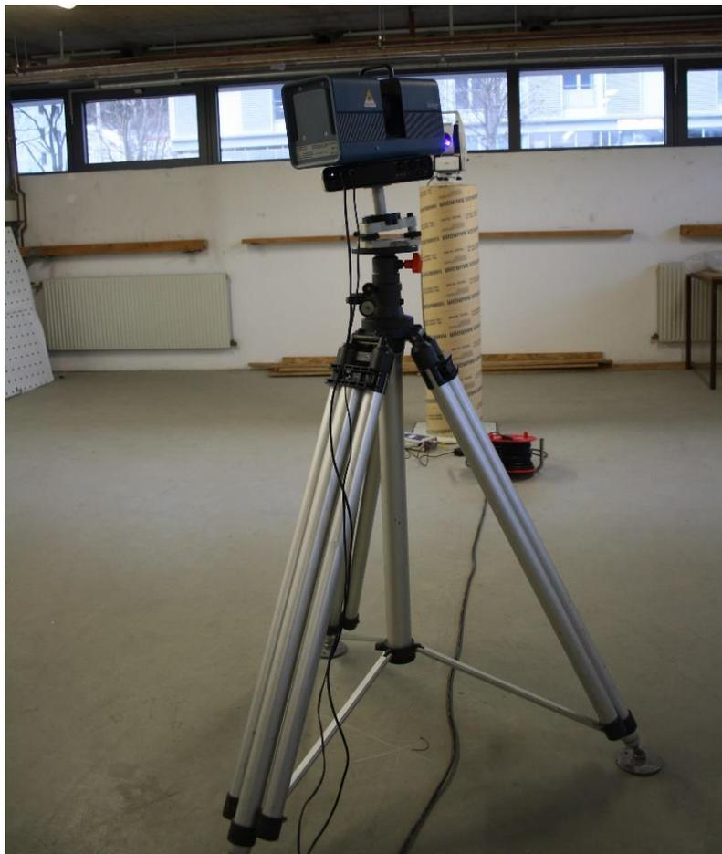
**Abbildung 28: Scan 07, maximale Neigung (5,8°) des Scanners**
