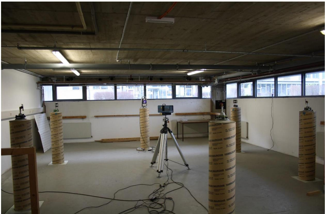
**Abbildung 27: Versuchsaufbau – Scanner im Zentrum des Festpunktfeldes**
