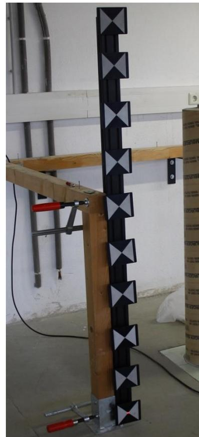
**Abbildung 44: Befestigung und Messung der Targetleiste in vertikaler Position V1**
