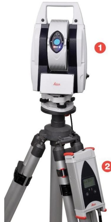
**Abbildung 13: Leica AT 401, mit Sensoreinheit (1) und Controller (2)**
