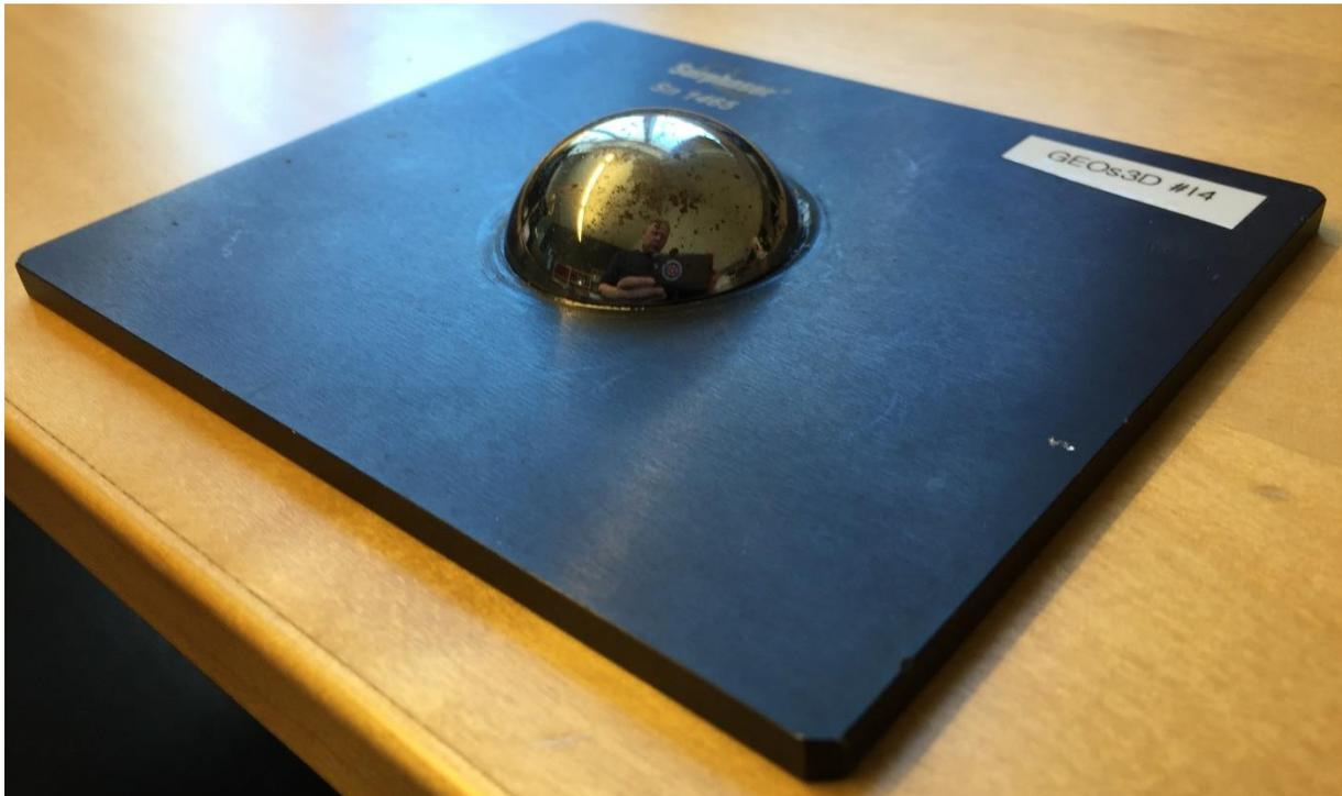
**Abbildung 19: Surphaser Flachtarget, Halbkugel auf der Rückseite**
