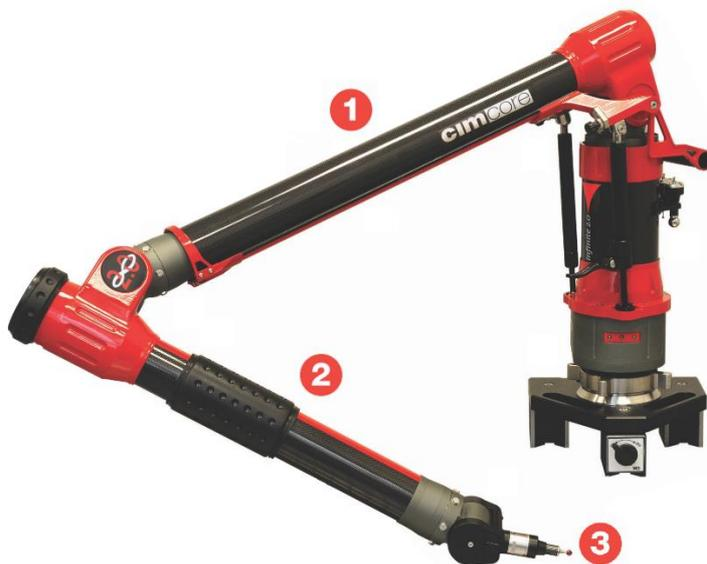
**Abbildung 15: Messarm CimCore Infinite 2.0 mit den Armteilen (1) und (2) sowie Sensorkopf mit Messtaster (3)**
