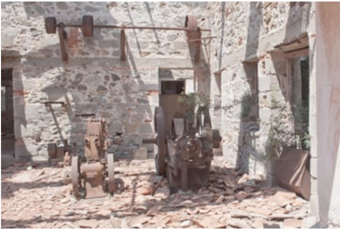
Abb. 20: Verbrennungsmotor, Dampfmaschine und Transmissionswelle
