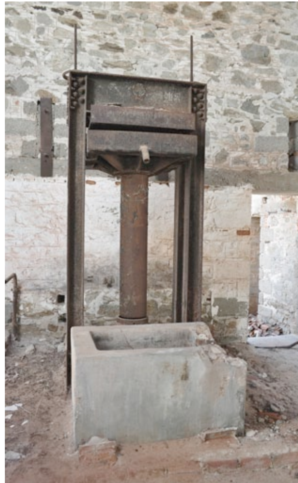
Abb. 23: Spindelpresse mit Handrad
