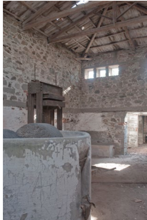
Abb. 29: Produktionsraum mit Kollergang, Spindelpresse und Klärbecken
