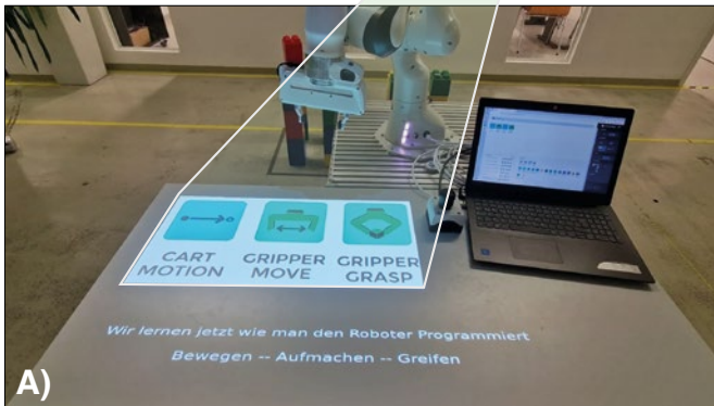
Bild 2: Darstellung ausgewählter Use Cases: A.) Erlernen der Programmierung eines kollaborativen Roboters mit SAR-Anweisungen; B.) Lernvideos integriert direkt im Arbeitsbereich am Beispiel der Bedienung einer industriellen Kreissäge; C.) Interaktive Projektionen, dargestellt am Beispiel der Auswahl des richtigen Sägeblatts passend zu konkreten Materialeigenschaften.
