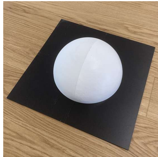
Abb. 6.3: Kugel-Target aus 3D-Druck
