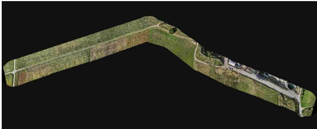
Abb. 6.7: Prozessierte LiDAR-Punktwolke des Güterweges mit RGB-Information
