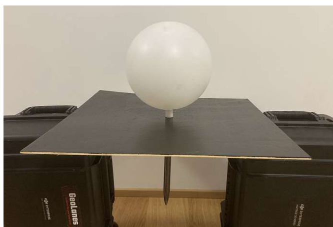
(b) Exakte Positionierung der Kugel über dem Rohr
