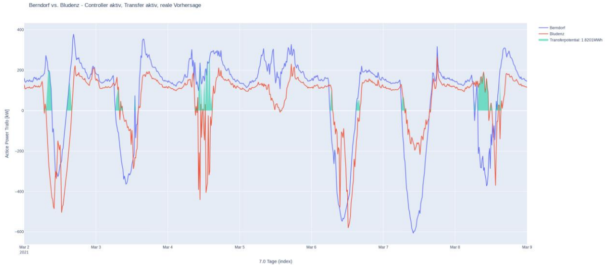
Abbildung 3: Vergleich und Transferpotential der zwei Standorte mit jeweils optimiertem Verbrauch, Erzeugung und Transferpotential bei realen Vorhersagewerten - Transferpotential: 1,8201 MWh (+3,38%)
