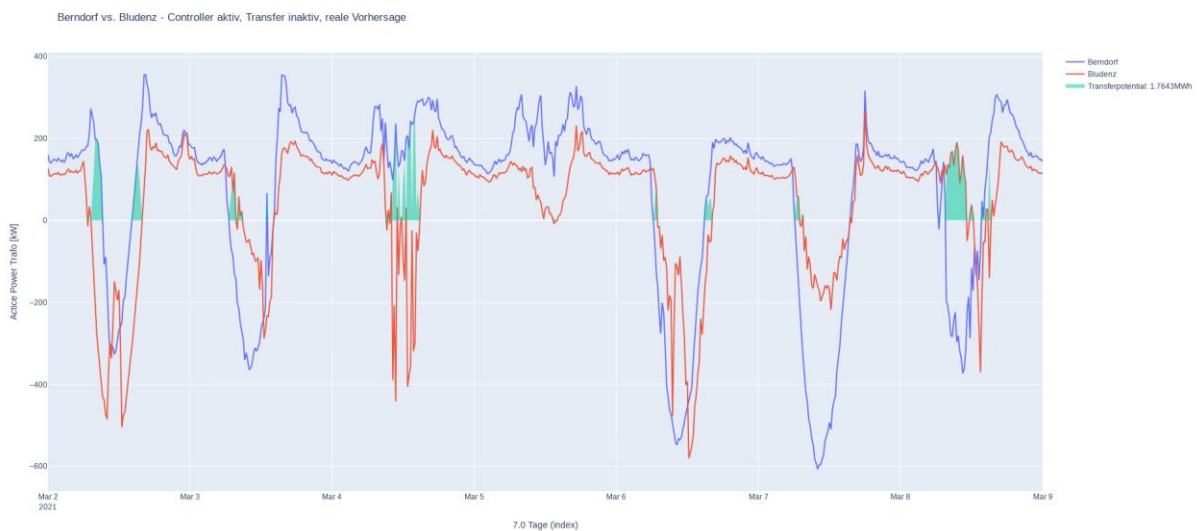
Abbildung 2: Vergleich und Transferpotential der zwei Standorte mit jeweils optimiertem Verbrauch und Erzeugung - Transferpotential: 1,7643 MWh (+0,21%)
