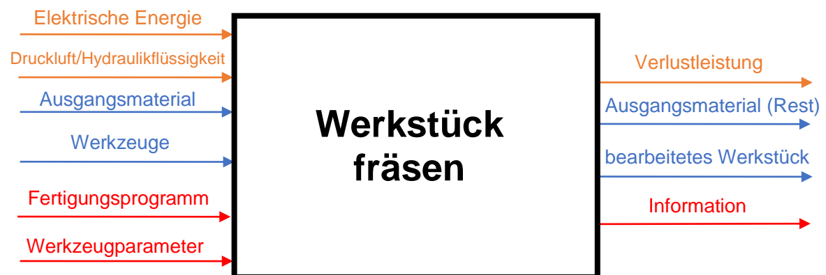
Abbildung 19: Blackboxmodell der Fräsmaschine
