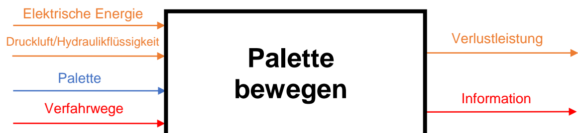
Abbildung 20: Blackboxmodell des Handlingroboters
