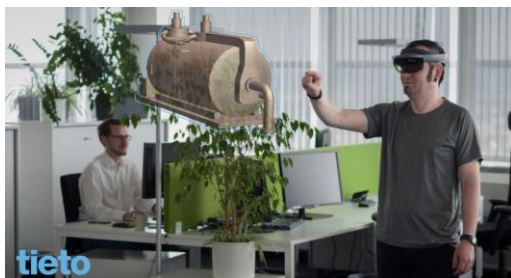
Abbildung 12: Überprüfung einer Maschine mit der Hololens
