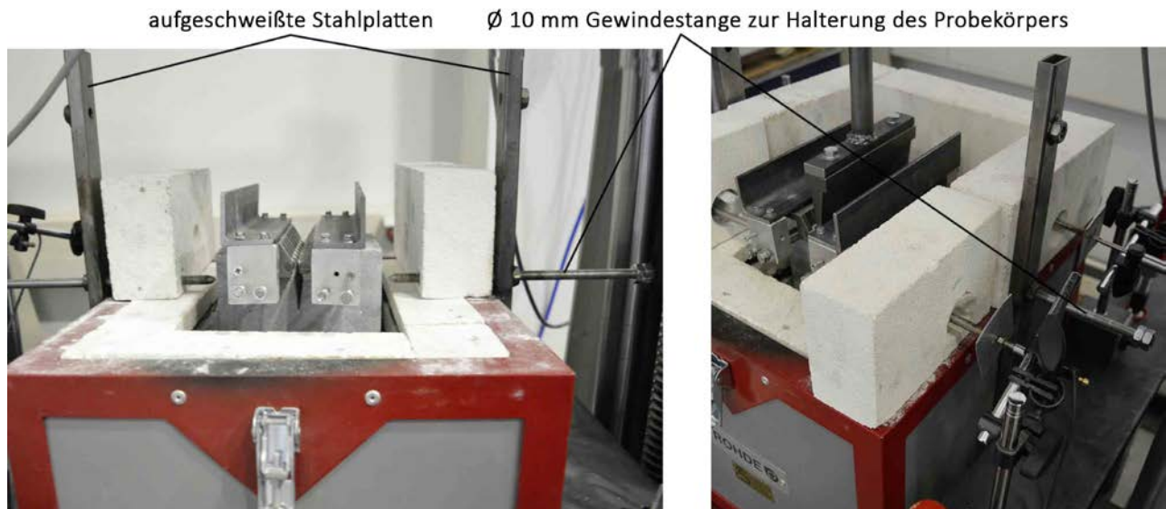
Abbildung 5.16: Detail – Halterung des Probekörpers
