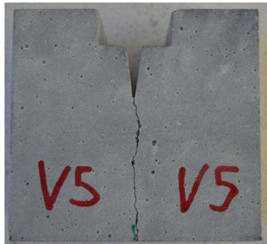
Abbildung 6.11: Rissbild V5 mit h_{lig} = 8 \text{ cm} - zulässiger Rissverlauf
