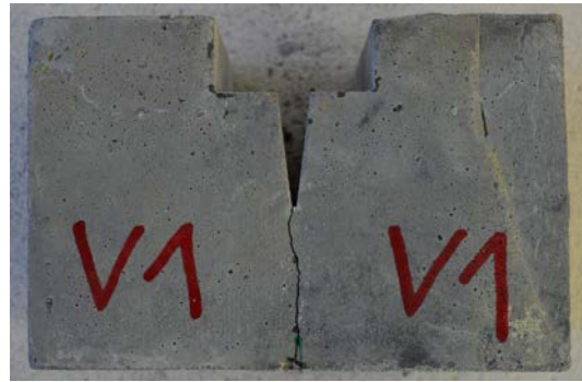
Abbildung 6.9: Rissbild V1 mit h_{lig} = 4 \text{ cm} - zulässiger Rissverlauf
