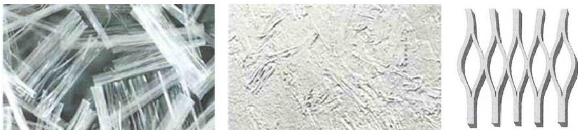
Abbildung 2.8: Fibrillierte Fasern - links: Fasern [29]; mitte: Betonoberfläche der Fasern [29]; rechts: Netzartige Struktur der fibrillierten Fasern [27]
