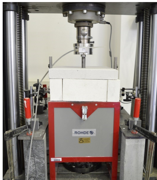
Abbildung 5.9: Prüfvorrichtung der Keilspaltmethode unter Temperatur
