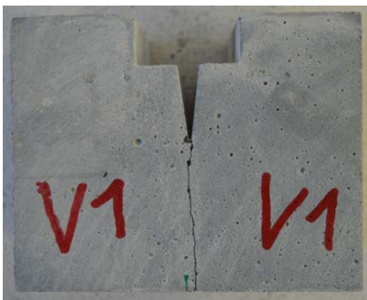
Abbildung 6.10: Rissbild V1 mit h_{lig} = 6 \text{ cm} - zulässiger Rissverlauf
