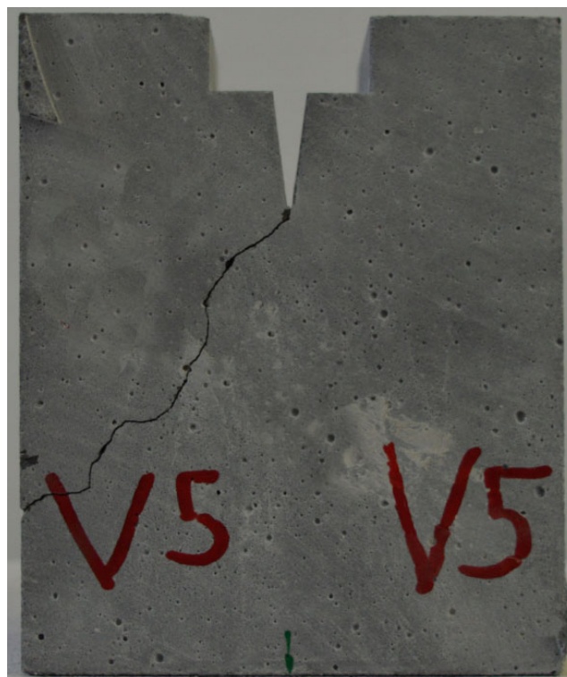
Abbildung 6.4: Unzulässiger Rissverlauf eines Versuches mit 12 cm Ligamenthöhe
