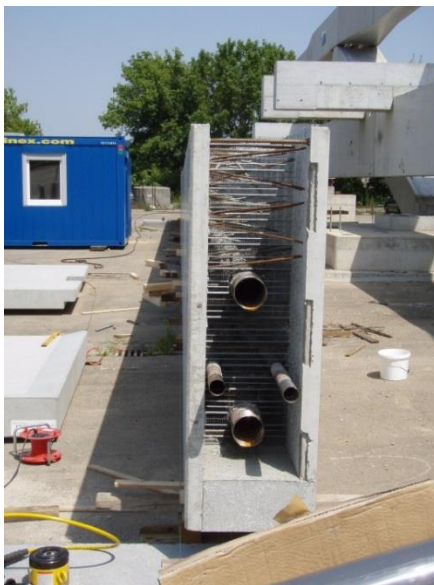
Abbildung II-26: Querschnitt des Versuchsträgers aus Doppelwandelementen
