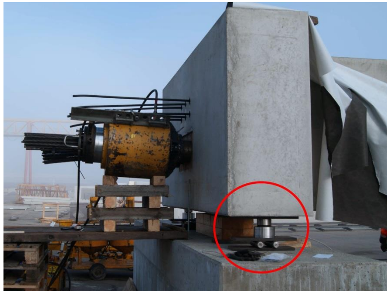
Abbildung III-6: Auflagersituation Versuchsträger –Spannpresse am Endverankerungsblock - längsverschiebliches Rollenlager
