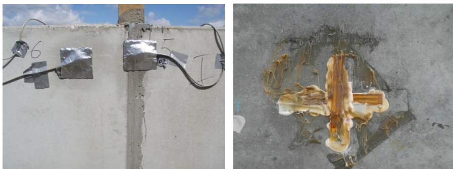
Abbildung III-5: Dehnmessstreifen – DMS mit Kautschukband-Abdichtung - Halbbrücke nach Entfernen der Abdeckfolie
