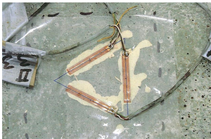
Abbildung III-30: Anordnung der DMS als gleichseitiges Dreieck
