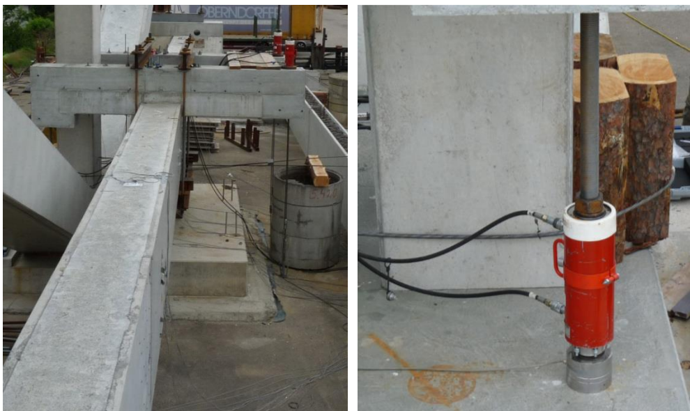
Abbildung III-24: Lasteinleitung – links: Pressenanordnung auf Zugseite – rechts: Kraftmessdose unter der Presse auf Druckseite
