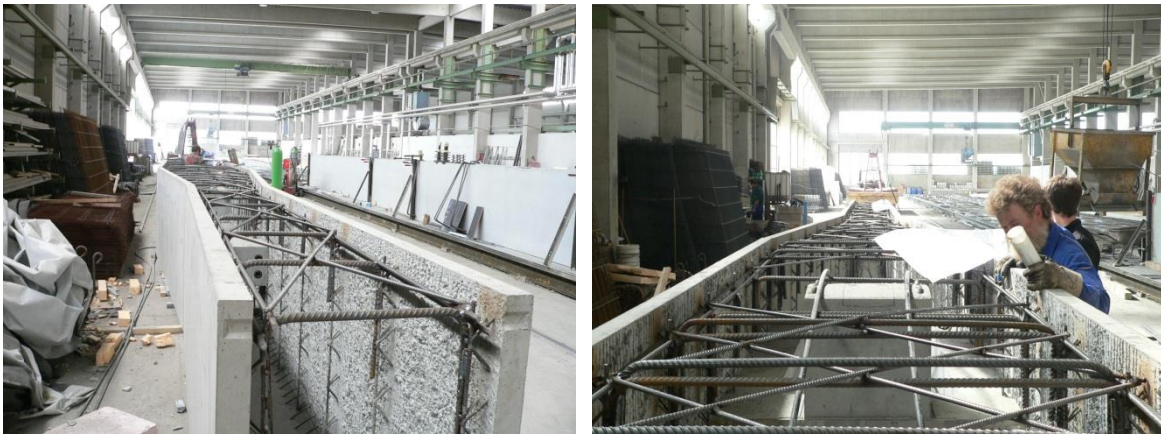
Abbildung II-7: Anschweißen des aussteifenden Horizontalverbandes
