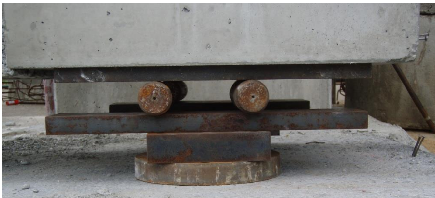
Abbildung III-81: Längsverschiebliches Lager des Versuchsträgers aus Doppelwandelementen
