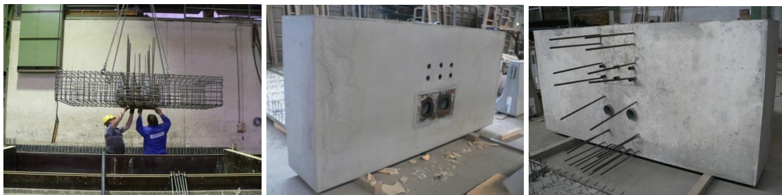
Abbildung II-18: Verankerungsblock mit Spanngliedverankerungen
