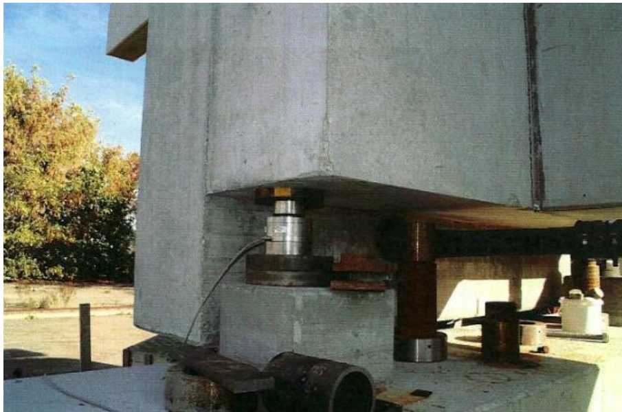
Abbildung III-26: Kraftmessdosen zur Bestimmung der Auflagerreaktionen
