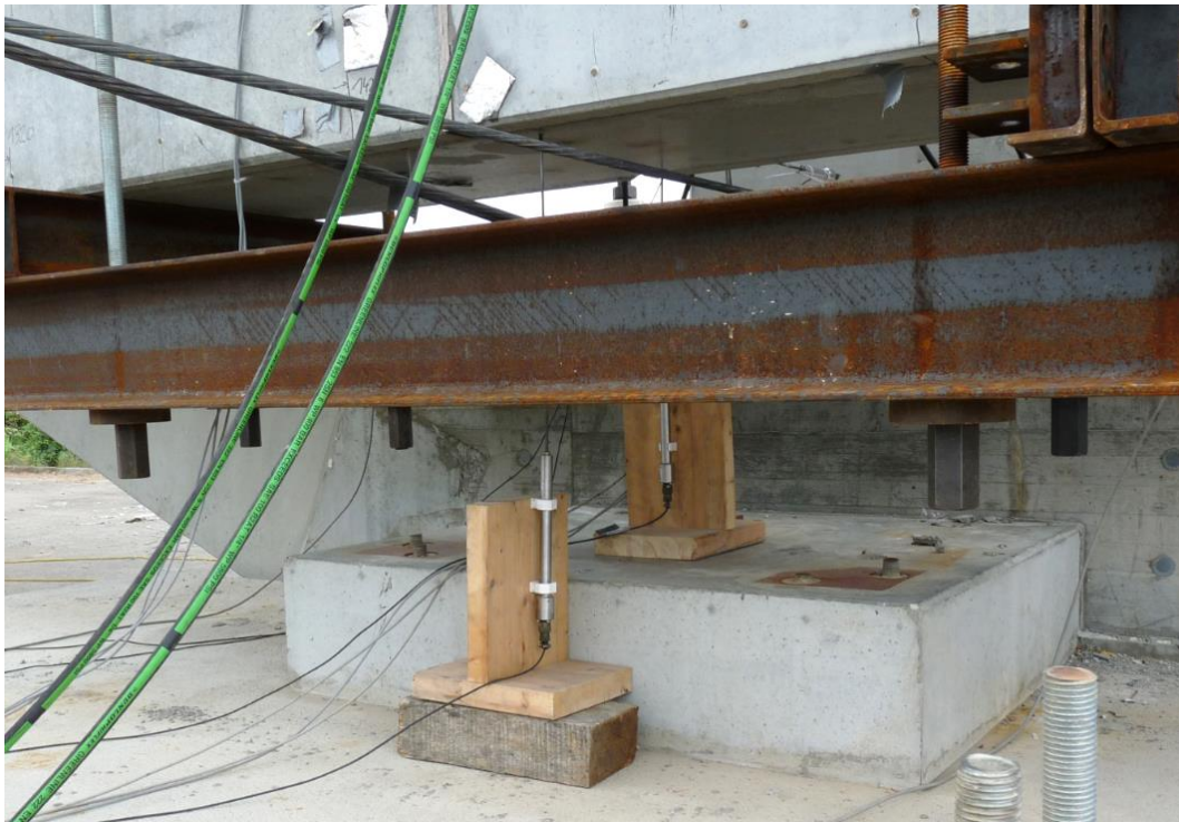
Abbildung III-32: Wegaufnehmer an der Unterseite des Versuchsträgers
