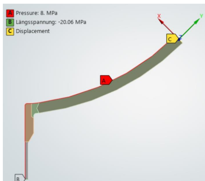
Abbildung 4.4: Aufgebrachte Lasten und Randbedingungen der Kugel-Stutzen-Verbindung
