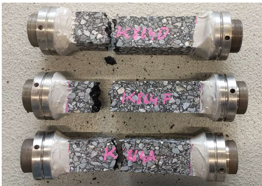
Abb. 3.3: Gerissene Probekörper nach abgeschlossenem Versuch
