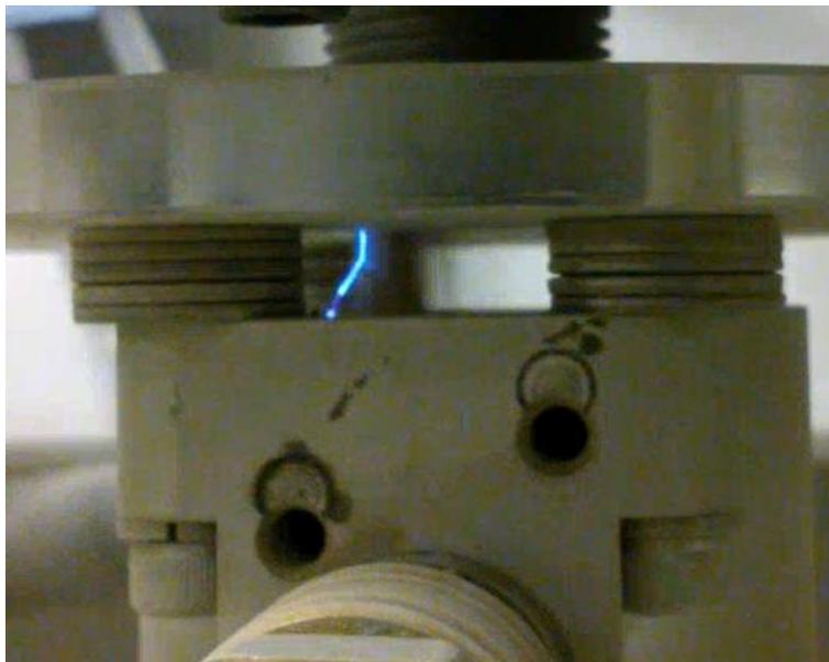
Abbildung 5.17 Entladungsblitz zwischen Vulkollan-ZRS und Ejektor
