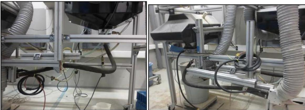
**Abbildung 5.23 Prüfaufbau pneumatische Sandungsanlage an Wagenende 1 (WE1) und Wagenende 2 (WE2)**
