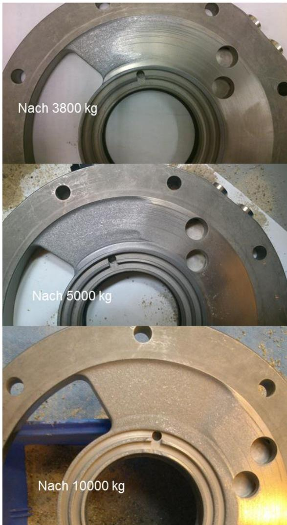
**Abbildung 5.13 Verschleißmuster Einlass Gehäusedeckplatte**
