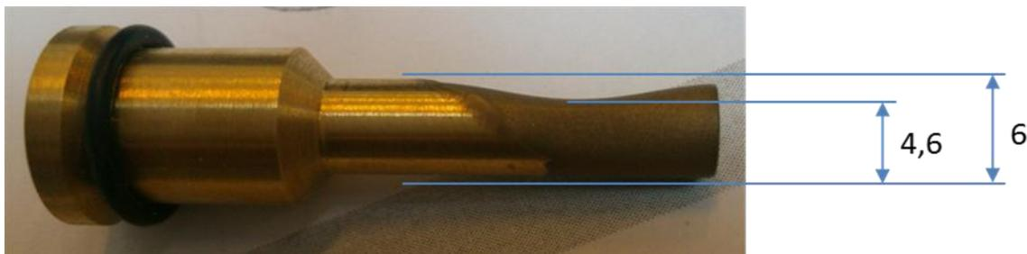
**Abbildung 5.22 Verschleiß an der Einspritzdüse**
