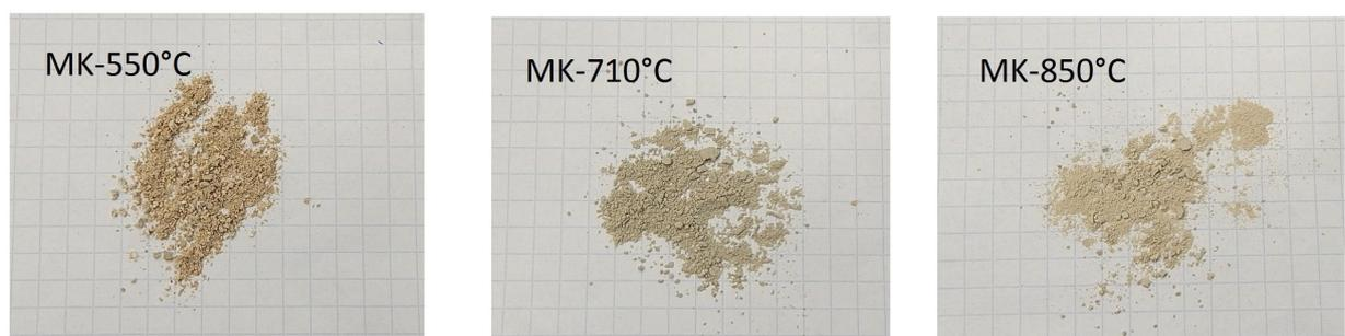
Abbildung B.2: Ascheproben MK, Veraschungstemperaturen 550 °C, 710 °C und 850 °C
