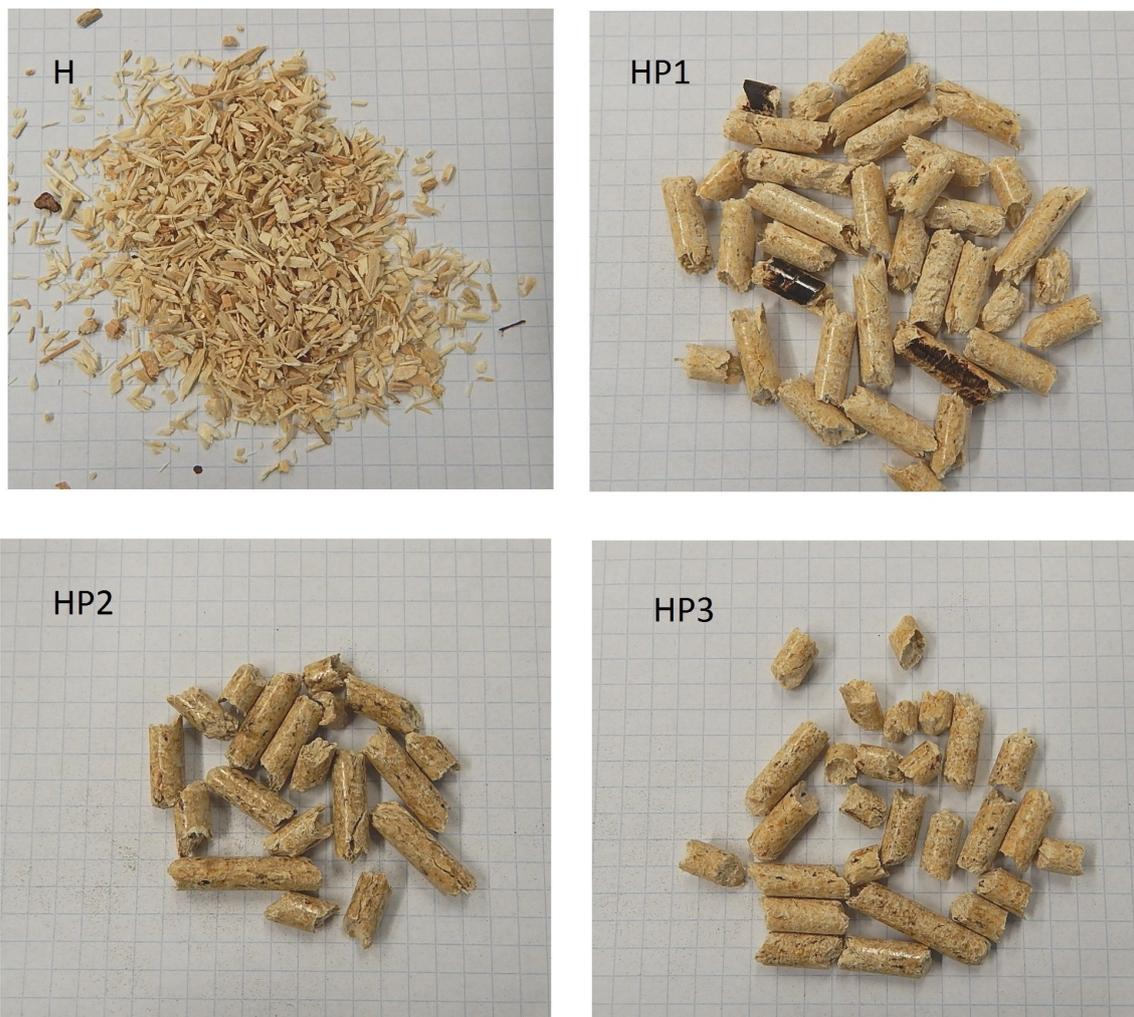
Abbildung 4.1: Verwendete Proben Holzspäne (H) und Holzpellets (HP1, HP2 und HP3)
