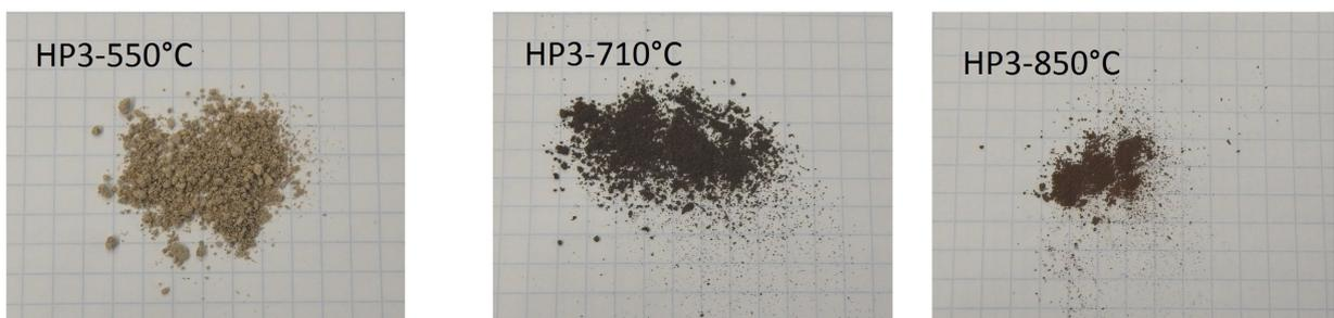
Abbildung B.1: Ascheproben HP3, Veraschungstemperaturen 550 °C, 710 °C und 850 °C
