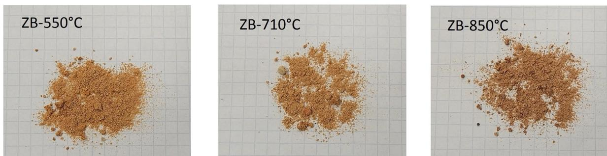
Abbildung B.5: Ascheproben ZB, Veraschungstemperaturen 550 °C, 710 °C und 850 °C
