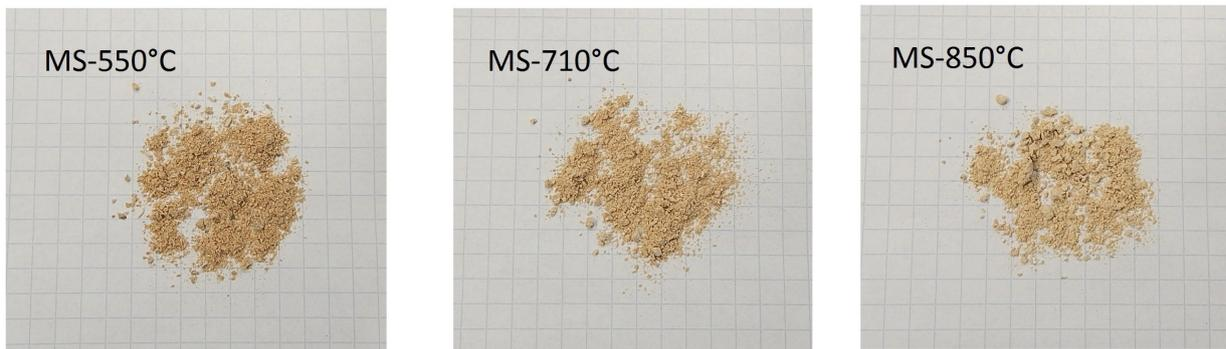
Abbildung B.3: Ascheproben MS, Veraschungstemperaturen 550 °C, 710 °C und 850 °C
