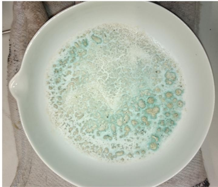
Abbildung 4.26: Probe OB-850°C-CaCO<sub>3</sub> nach der Veraschung
