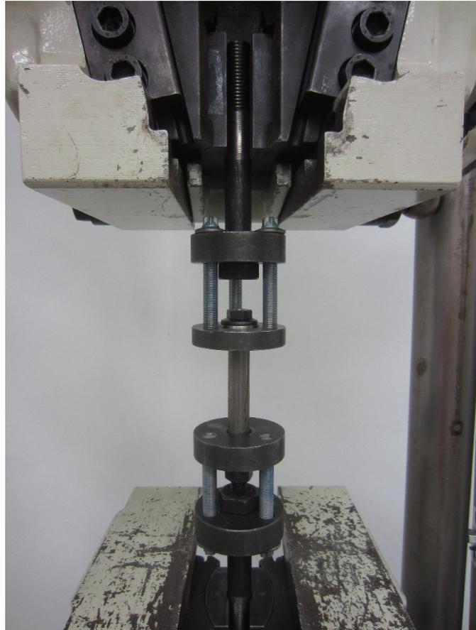
Abbildung 10: Schrauben Kalibrierung
