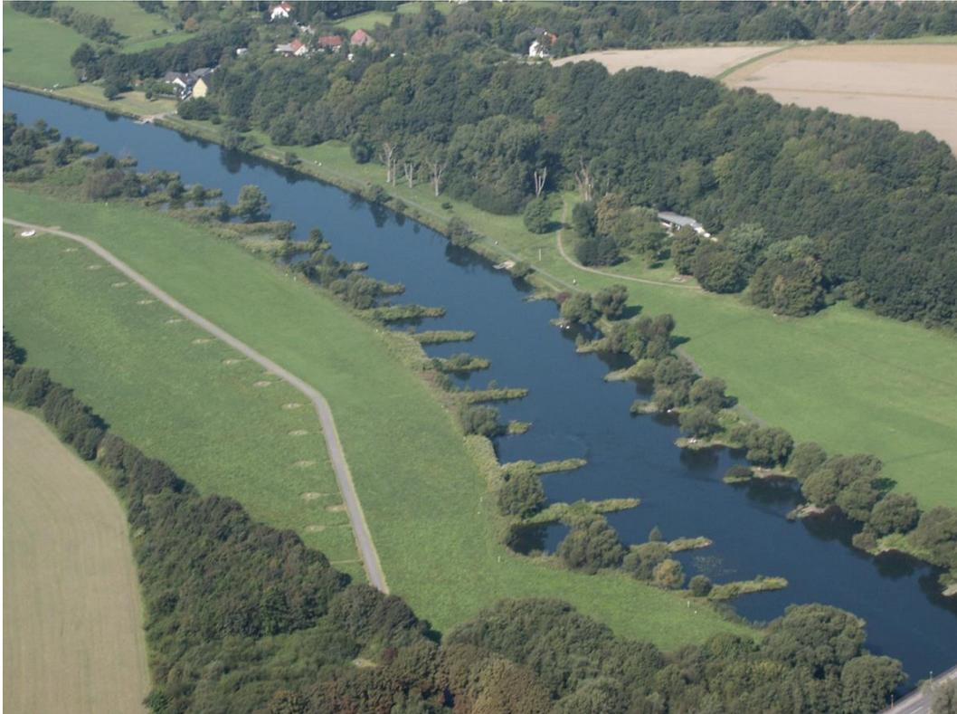
*Bild 3. 15 Buhnenpaare und linksseitige Buhnen an der Ruhr südlich von Bochum. (Quelle: de.wikipedia.org, Januar 2015)*
