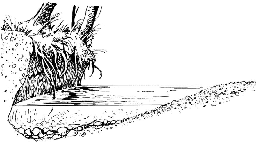
*Bild 2. 2 Prall- und Gleitufer (Quelle: Landschaftswasserbau und Flussmorphologie, Honsowitz)*
