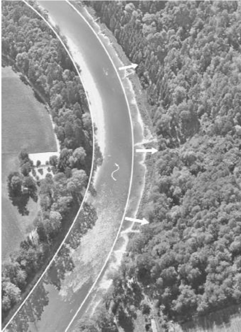
Bild 3. 32 Eigendynamische Aufweitung durch Seitenerosion (Quelle: Chr. Herrmann, 2003)
