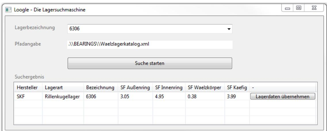
Abbildung 70: Suchergebnis/Zuweisung der Lagerdaten zu einem modellierten Lager
