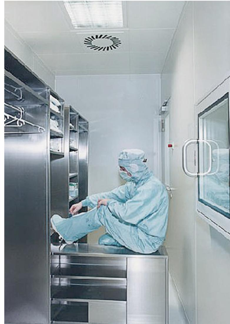
Abb.16: Reinraumschleuse (Umkleide)
