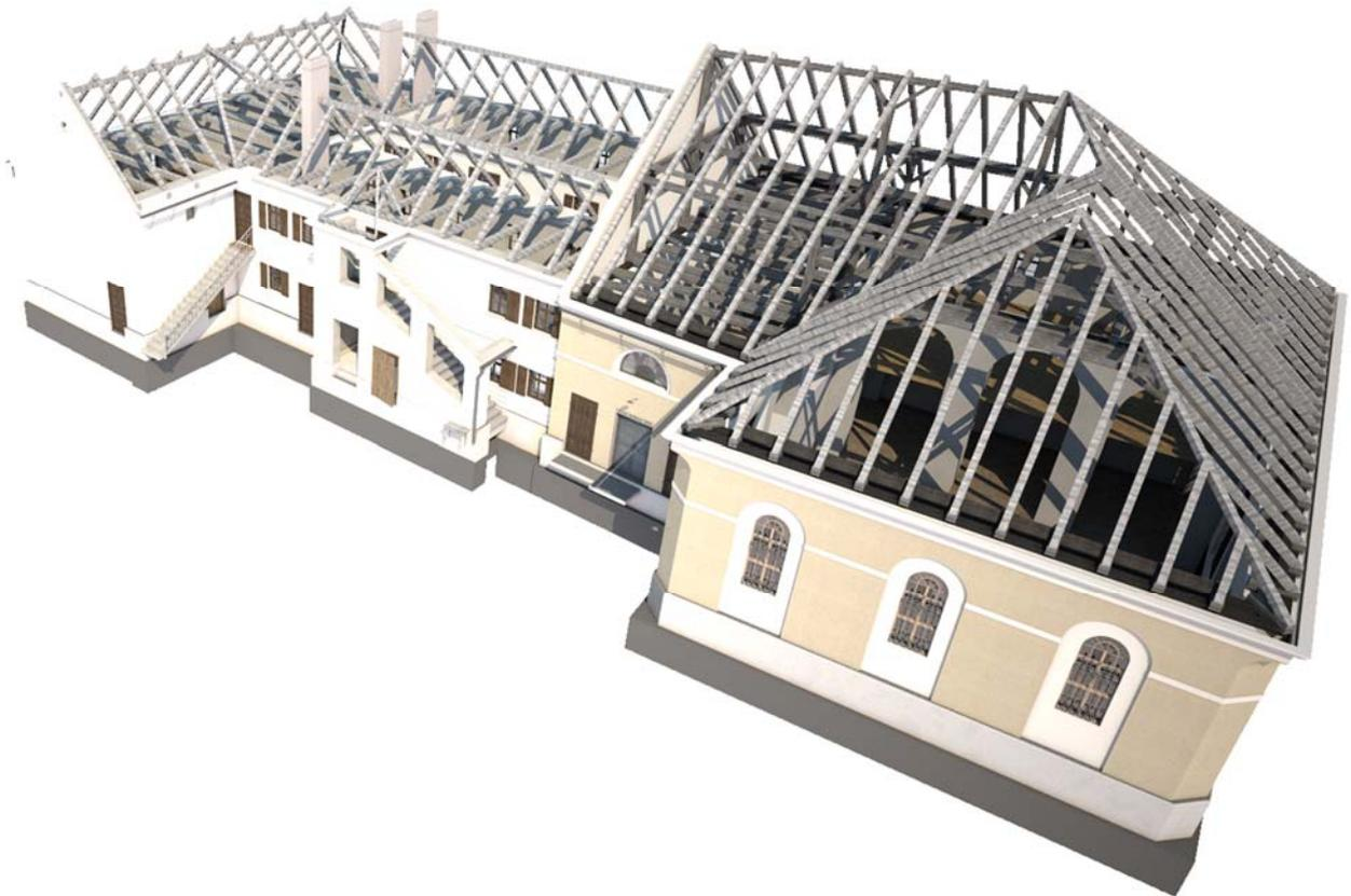
**Abb. 57** Rekonstruktion der Dachkonstruktion
