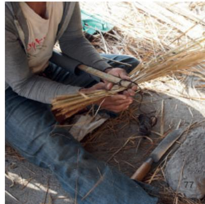
77-79 Herstellung eines raab: das *Alang-Alang*-Gras wird um eine Bambusstange gelegt und daraufhin zusammengenäht, dadurch entstehen die einzelnen Dachdeckungselemente
