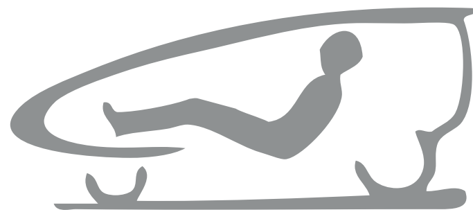
Kapsel_Position des Fahrers die Ausgestaltung nach der Form vom Segelflugzeug
