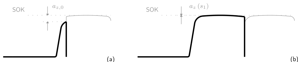
Abbildung 4.8.: Tiefe der Absenkung der Zungenschiene a_z(s) : (a) an der Stelle s_0 : a_z(s_0) = a_{z,0} ; (b) an der Stelle s_1 = s_0 + l_a : a_z(s_1) = 0 ; anliegendes Backenschienenprofil gemäß Abbildung 4.6 (grau), für die Verwendung relevanter Profiltile (schwarz).
