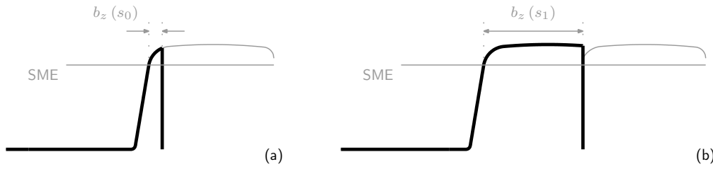
Abbildung 4.7.: Fahrkopfbreite des Zungenschienenprofils b_z(s) : (a) an der Stelle s_0 : b_z(s_0) = b_{z,0} ; (b) an der Stelle s_1 = s_0 + l_a : b_z(s_1) = b_{f,n} ; anliegendes Backenschienenprofil gemäß Abbildung 4.6 (grau), für die Verwendung relevanter Profilteile (schwarz).
