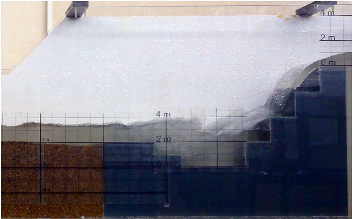
Abbildung 5.33: Ablösung des Überfallstrahls bei HQ<sub>10</sub> nach 15 Minuten bei der Variante 03B
