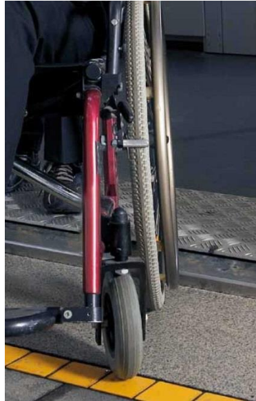
Abbildung 4.7: barrierefreie Einstiegsausbildung ohne Stufe, sowie Spaltüberbrückung mittels Trittbrett
