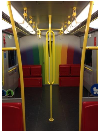
Abbildung 4.8: Auffangraum eines Siemens V-Wagens am Anfang und Ende des Zuges
