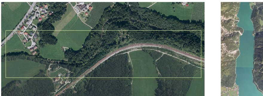
Abb. 18 Sichtbare Seamlines über Land (links entlang des Waldes, ab der Bildmitte entlang der Bahntrasse) und auf einem See
