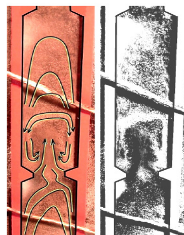
Abbildung 3.18: Strömungsprofil in den Einschnürungen [7]
