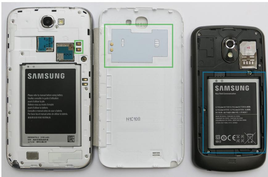
Abbildung 4.27: NFC Antennen der zwei Smartphones
