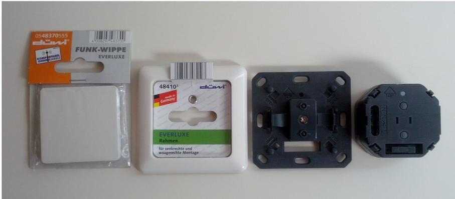
Abbildung 4.4: Einzelne Komponenten der Z-Wave Lichtschalter
