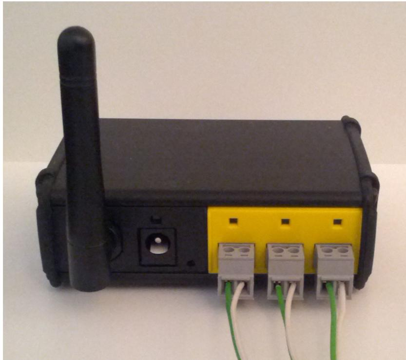
Abbildung 4.12: iTach WF2CC von Global Caché
